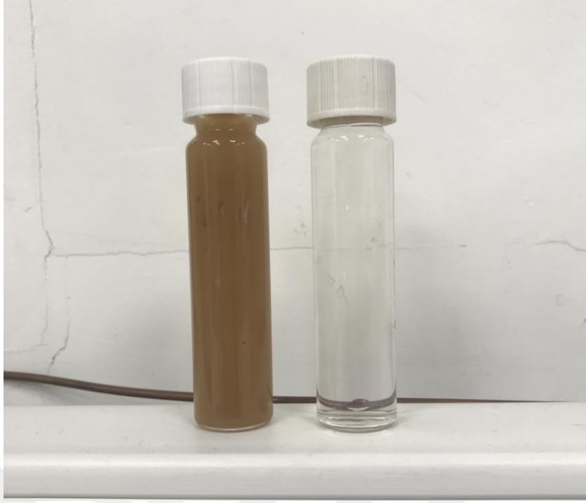
Şekil 5.3. Atıksuyun Filtrasyon Öncesi ve Sonrasına Ait Görüntüsü
