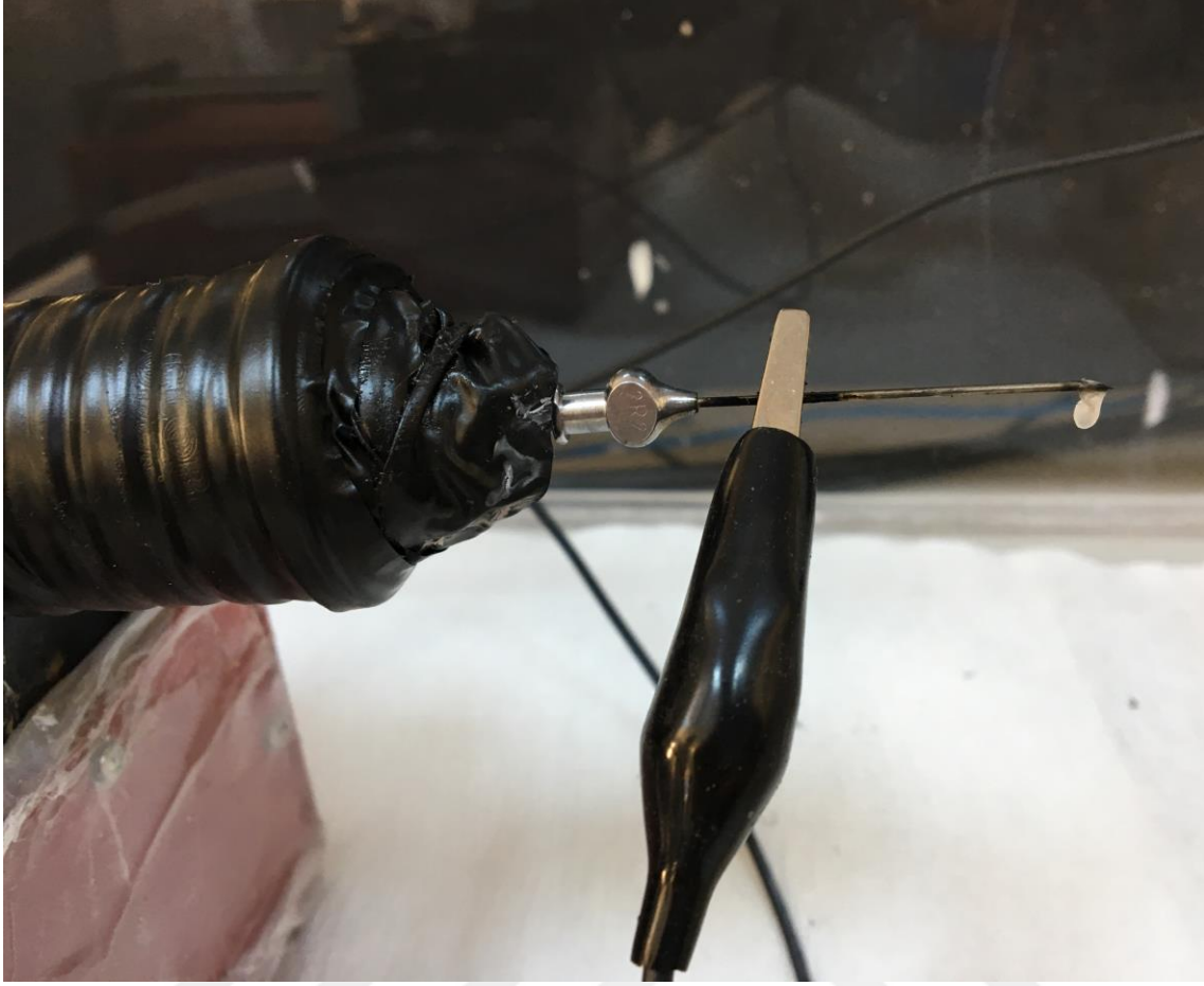
Şekil 4.4. Elektrosinning işlemi sırasında şırınga ucunda solüsyonun donması
