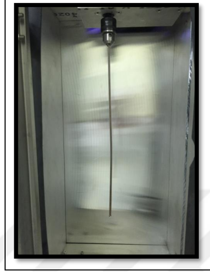
Şekil 3.4. Kürlenme prosesine hazır PU kateter
