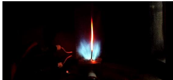
Şekil 4. 53. Yakıt zengin sönme limitinde %100 CNG alevi (sönmeden hemen önce, SS-0,2).
