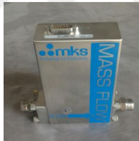
Şekil 3. 2. Kendinden oransal vanalı termal debi ölçer (MKS Type 1579).
