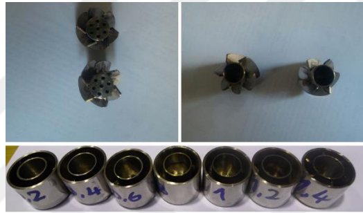
Şekil 3. 29. İmal edilen girdap üreteçlerinden bazıları.
