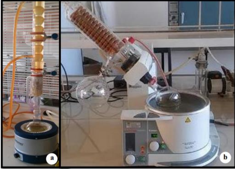
Şekil 3.8. Ekstraktların eldesinde kullanılan (a) soksilet düzeneği ve (b) rotary evaporatör
