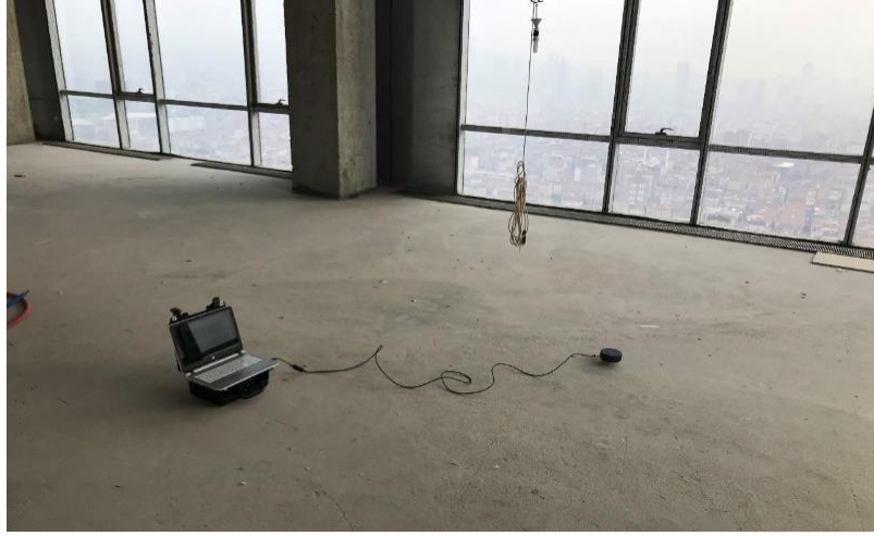
Şekil 5.19 Ümraniye'deki Kule'de titreşim ölçümü
