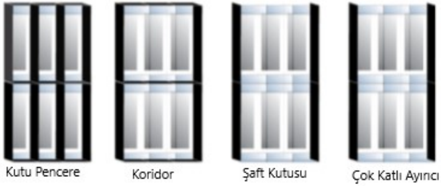
Şekil 3.4 : Çift kat giydirme cephe sistemleri tipleri: Ayırıcılar [9].
