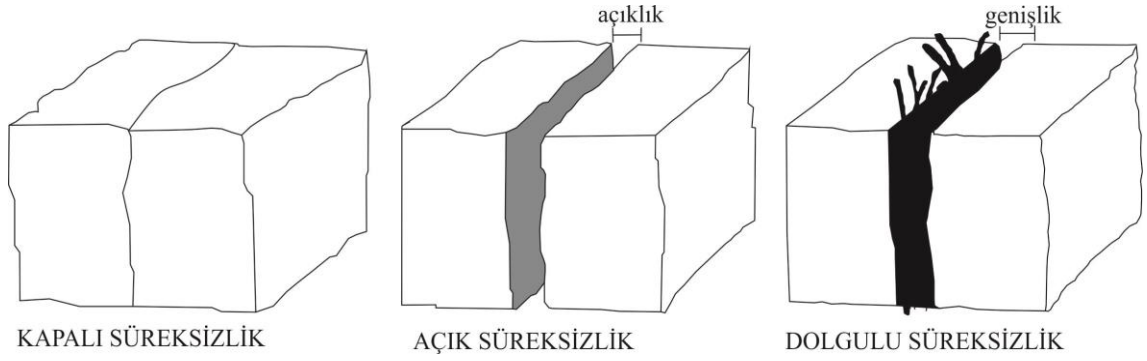
Şekil 2.8. Kapalı, açık ve dolgulu süreksizlikler (ISRM 2007)
