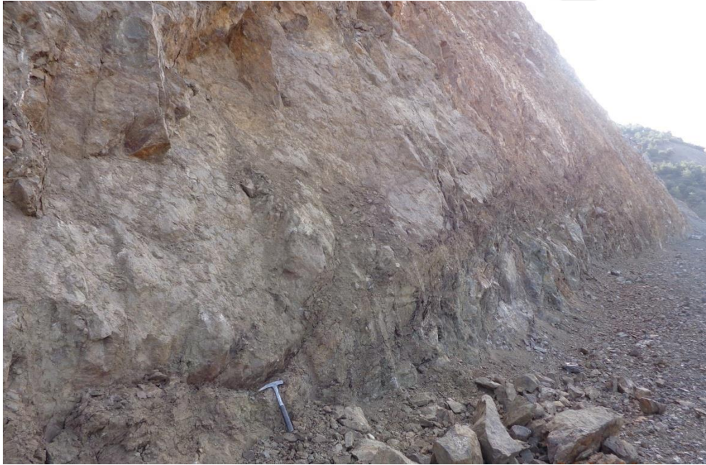
Şekil 4.4. Açık sahada gözlenen killeşmiş zayıflık zonları
