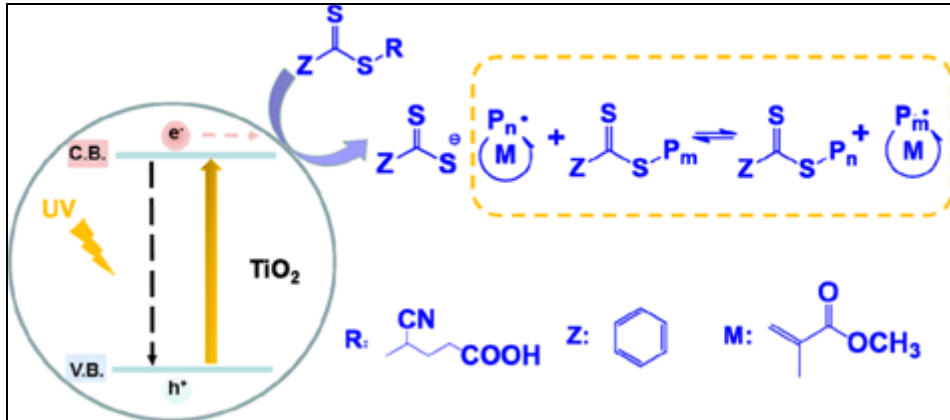
Şekil 2.7. Titanyum dioksit kullanılarak gerçekleştirilen PET-RAFT mekanizması [6]
