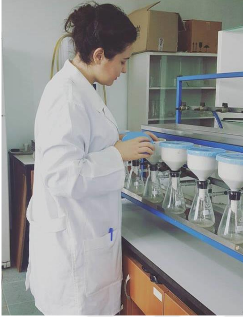
Şekil 3.4. Vakumlu saturasyon sisteminde süzük suyunun çıkarılması
