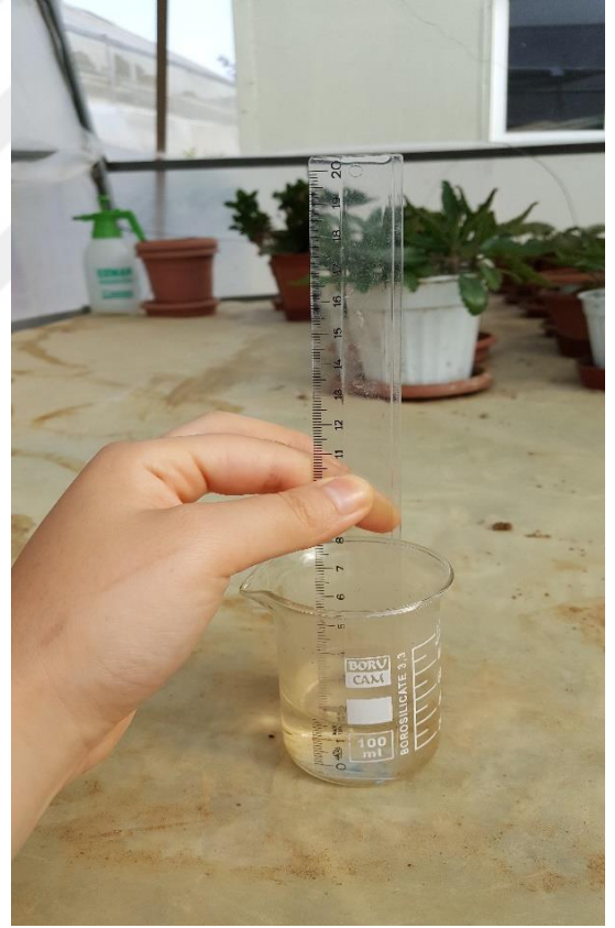
Şekil 3.8. Beherin sera içine yerleştirilmesi ve buharlaşma miktarının ölçülmesi
