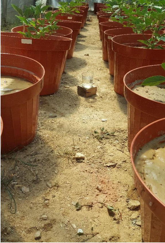
Şekil 3.8. Beherin sera içine yerleştirilmesi ve buharlaşma miktarının ölçülmesi
