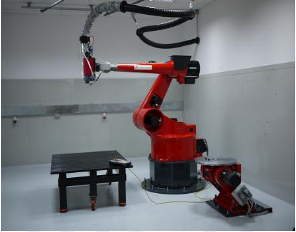
Şekil 3.1: Testler kapsamında kullanılan yüksek güçlü diyot lazer (Reis GmbH & Co Maschinenbau-Fabric GmbH, Germany).
