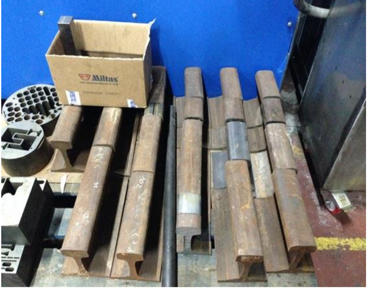
Şekil 3.2: Temin edilen R260 kalitede ray çelikleri (UIC 60E1).
