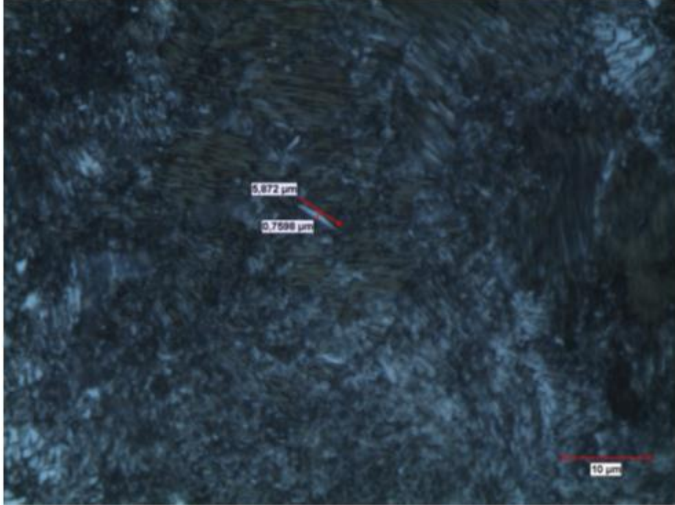
Şekil 4.67: 1.500X büyütmede sertleştirilmiş bölgede kalıntı östenit gösterimi.
