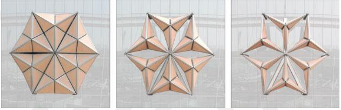
Şekil 37 : Cephe gölgeleme modülünün kapalı (sağda) ve açık (solda) hali (Url-13).
