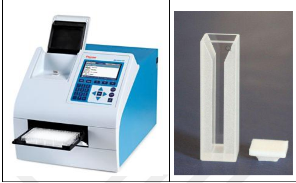
Fotoğraf 1.2. Ultraviyole-Görünür spektrofotometresi (Thermo Scientific- Multiskan GO) ve küvetleri.
