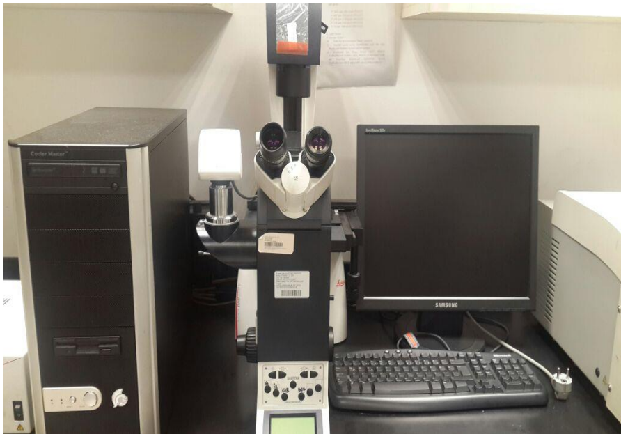
Resim 3.9. Floresans mikroskop(Leica DMI 4000B)
