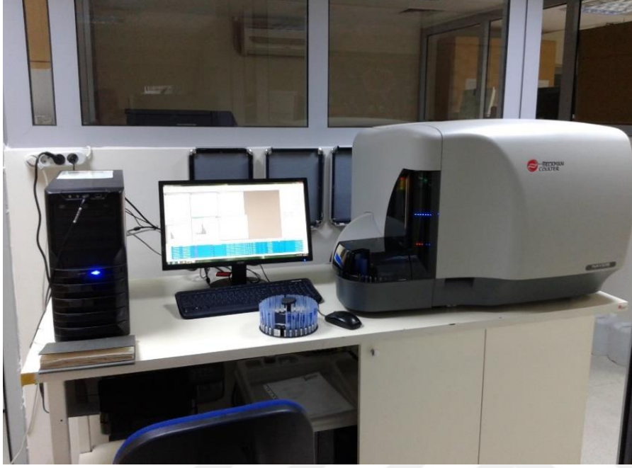
Resim 3.8. Akım sitometri cihazı (Beckman Coulter)
