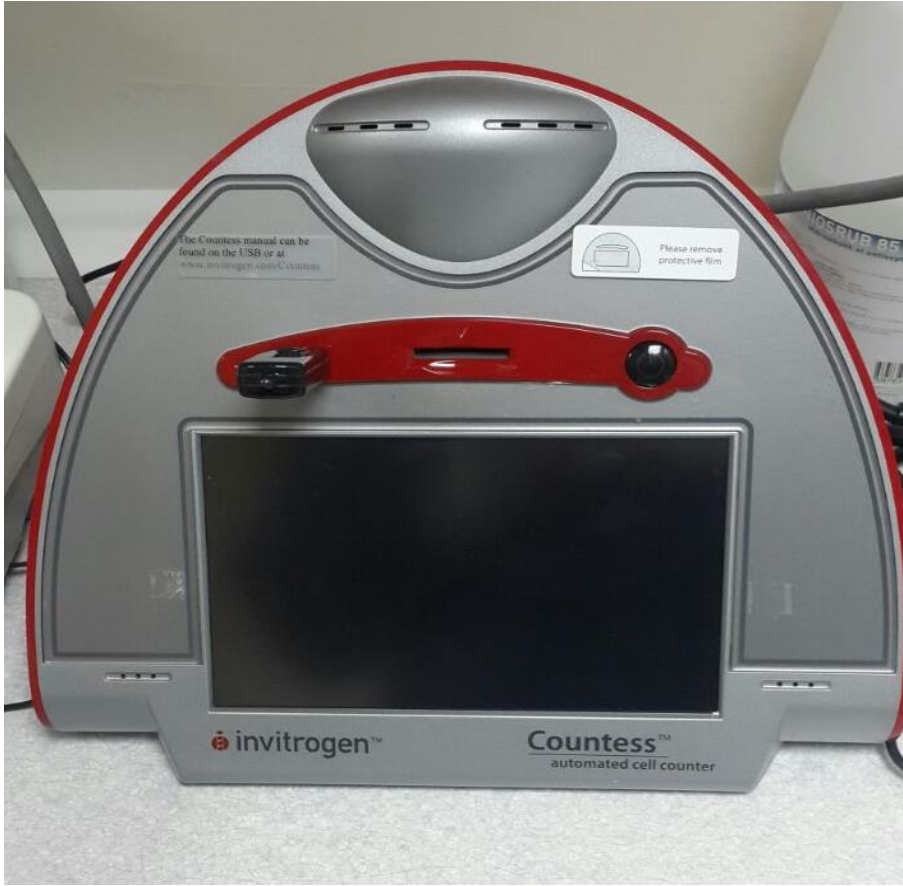
Resim 3.1. Hücre sayım cihazı (İnvitrogen)
