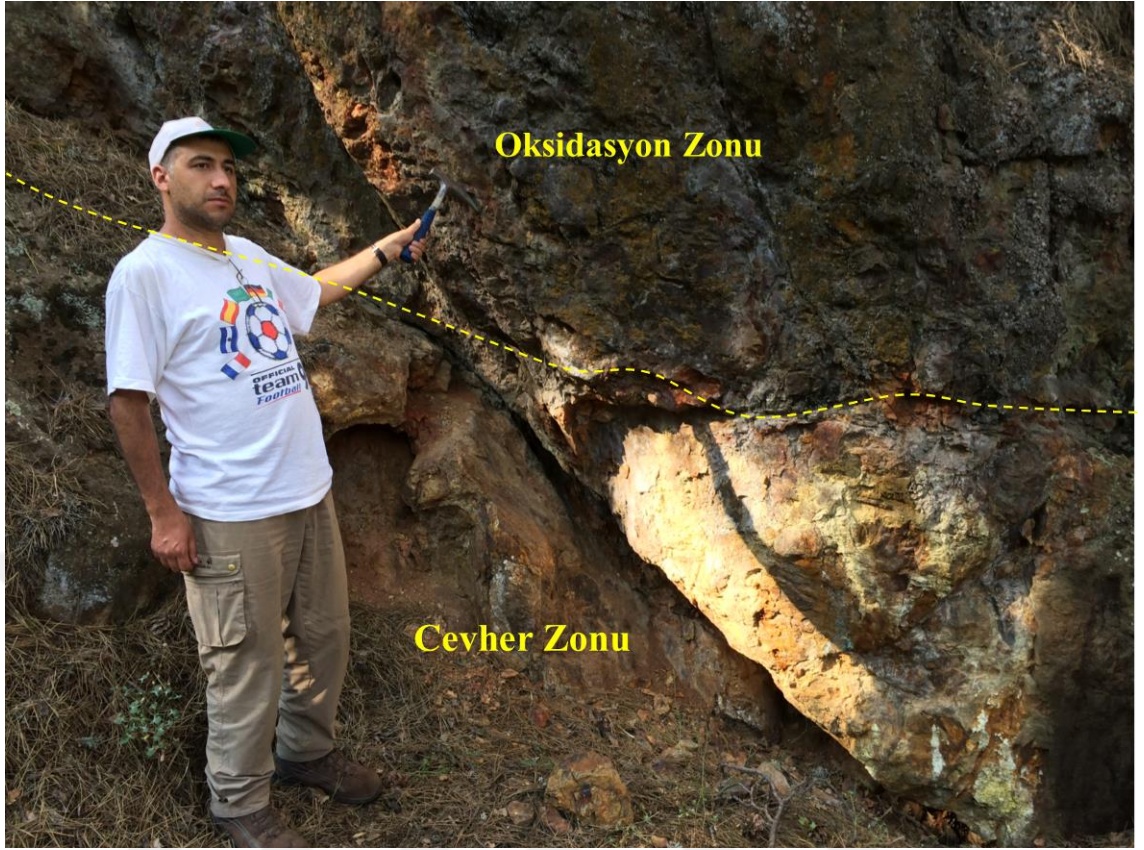
Şekil 5.34: Dedeninyurdu \text{Cu}\pm\text{Zn} cevherleşmesinde birincil cevher zonu ile oksidasyon zonu genel görünümü (Güneyden Kuzeye Bakış).
