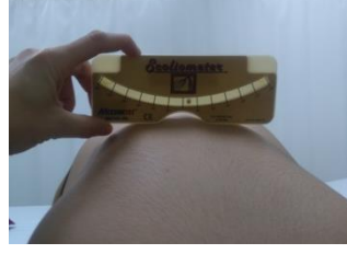
Şekil 6. Skolyometre ile gövde rotasyon açısının ölçümü
