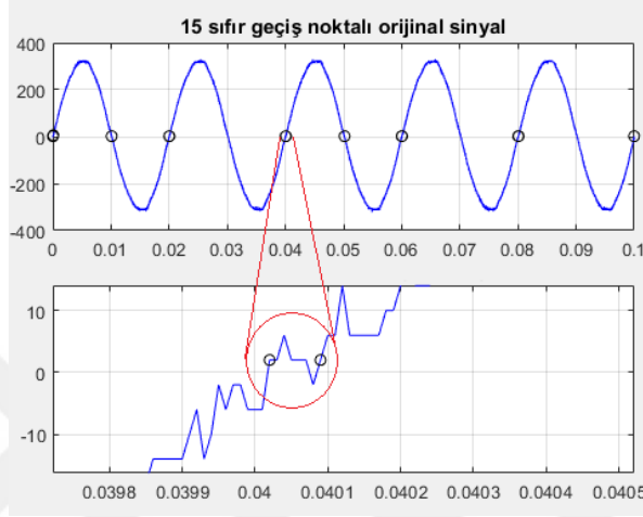
Şekil 4.1. Güç sinyalindeki gürültünün sıfır geçiş noktasındaki bozucu etkisi.
