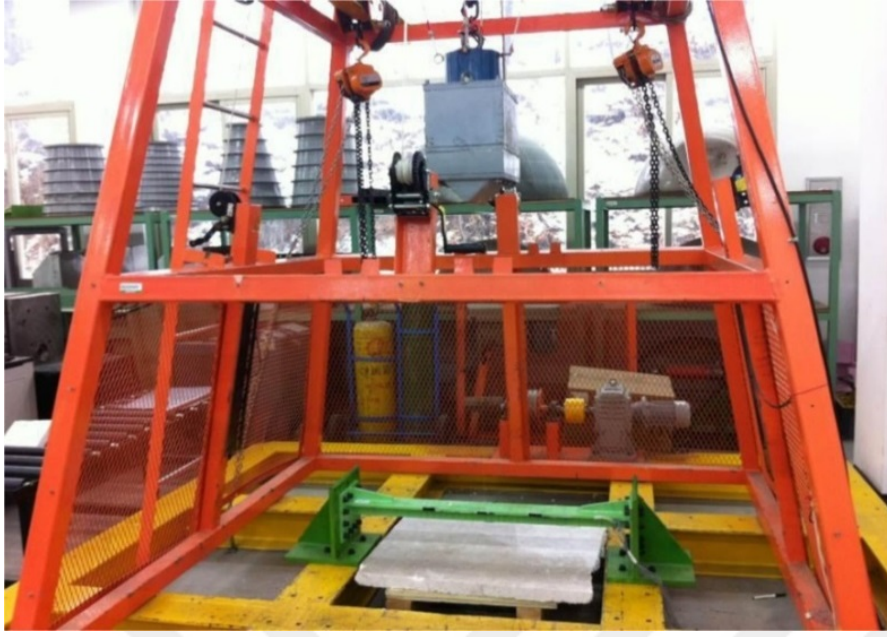
Şekil 1.4. Ağırlık düşürme düzeneği ve deney numunesi [20]
