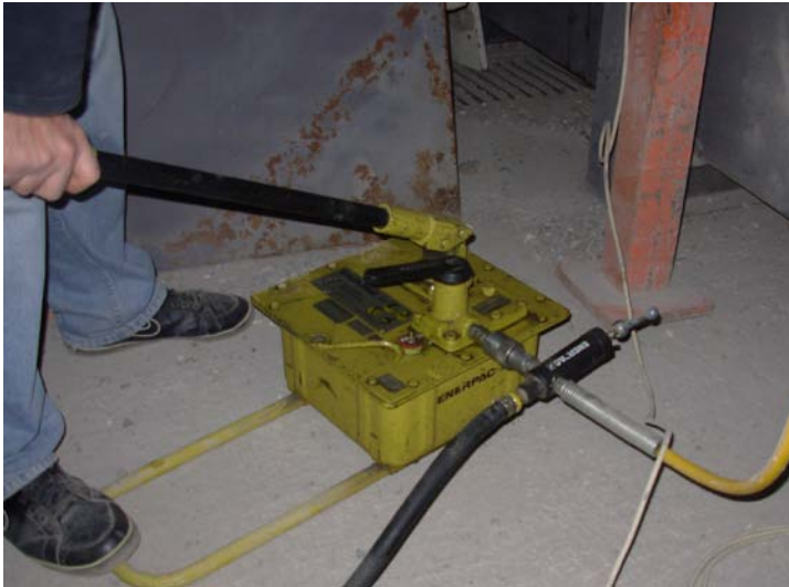
Resim 1.2. 300 kN basın uygulayabilen bir hidrolik kriko
