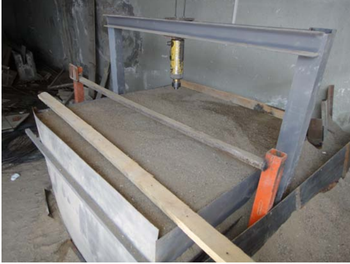
Resim 1.1. Deney düzeneđini oluřturan 2,00 x 2,00 x 1,00 m boyutlarında elik kutu
