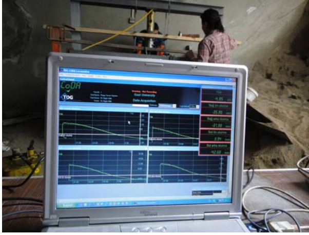
Resim 3.2. LVDT ölçümlerini kaydeden bilgisayar
