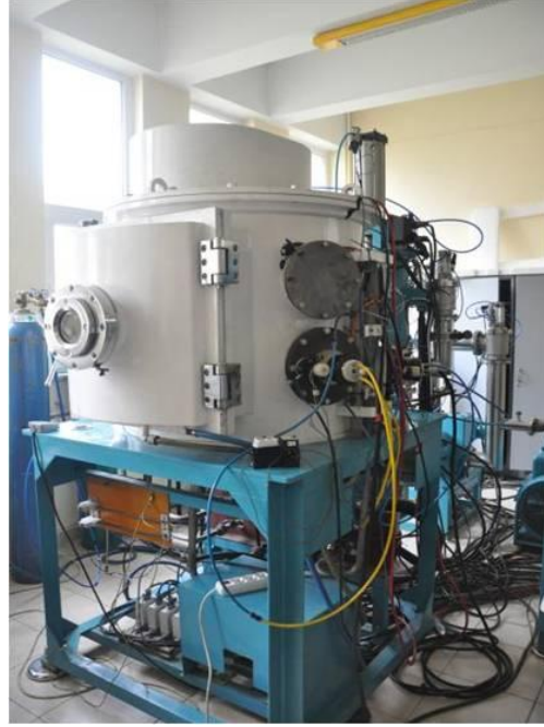
Şekil 3.1 : Katodik ark FBB kaplamalarda kullanılan cihazın görünümü
