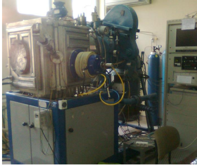
Şekil 5.2 : Fiziksel Buhar Biriktirme kaplama cihazı
