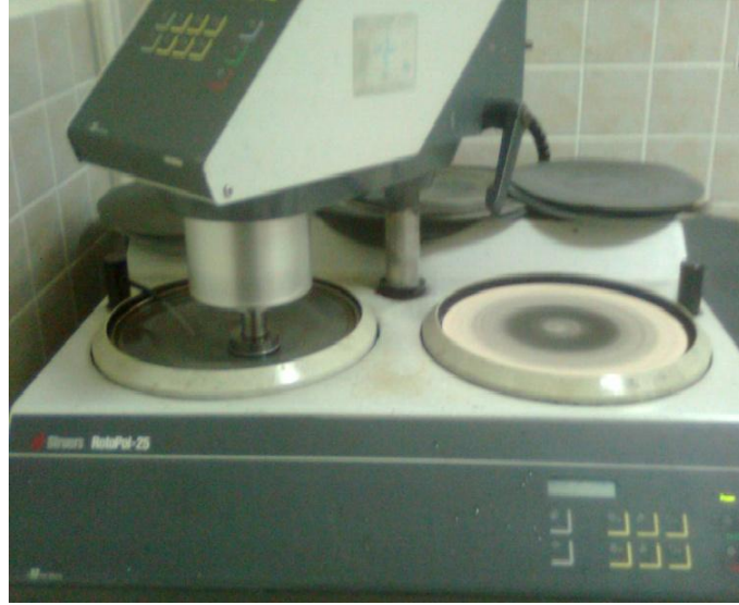
Şekil 5.1 : Struers RotoPol-25 parlatma cihazı
