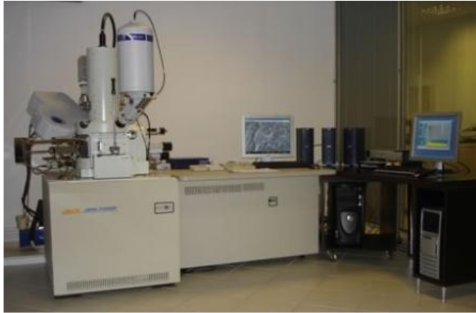
Şekil 5.4 : JEOL JSM-7300 model SEM
