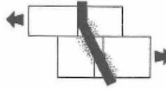
Şekil 5.14: Bulonlu birleşim detayı Mod-3 göçme mekanizması.
