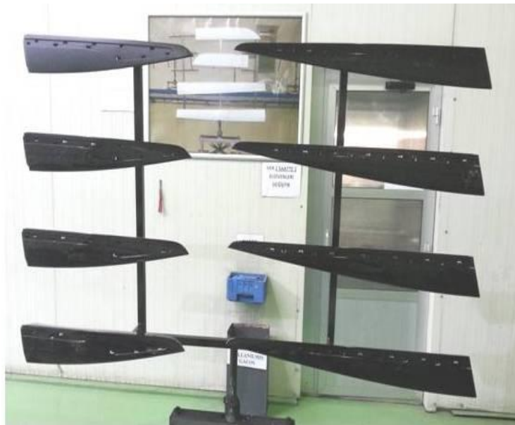
Şekil 3.17. Yeni durum kapı çıtası boyama askısı
