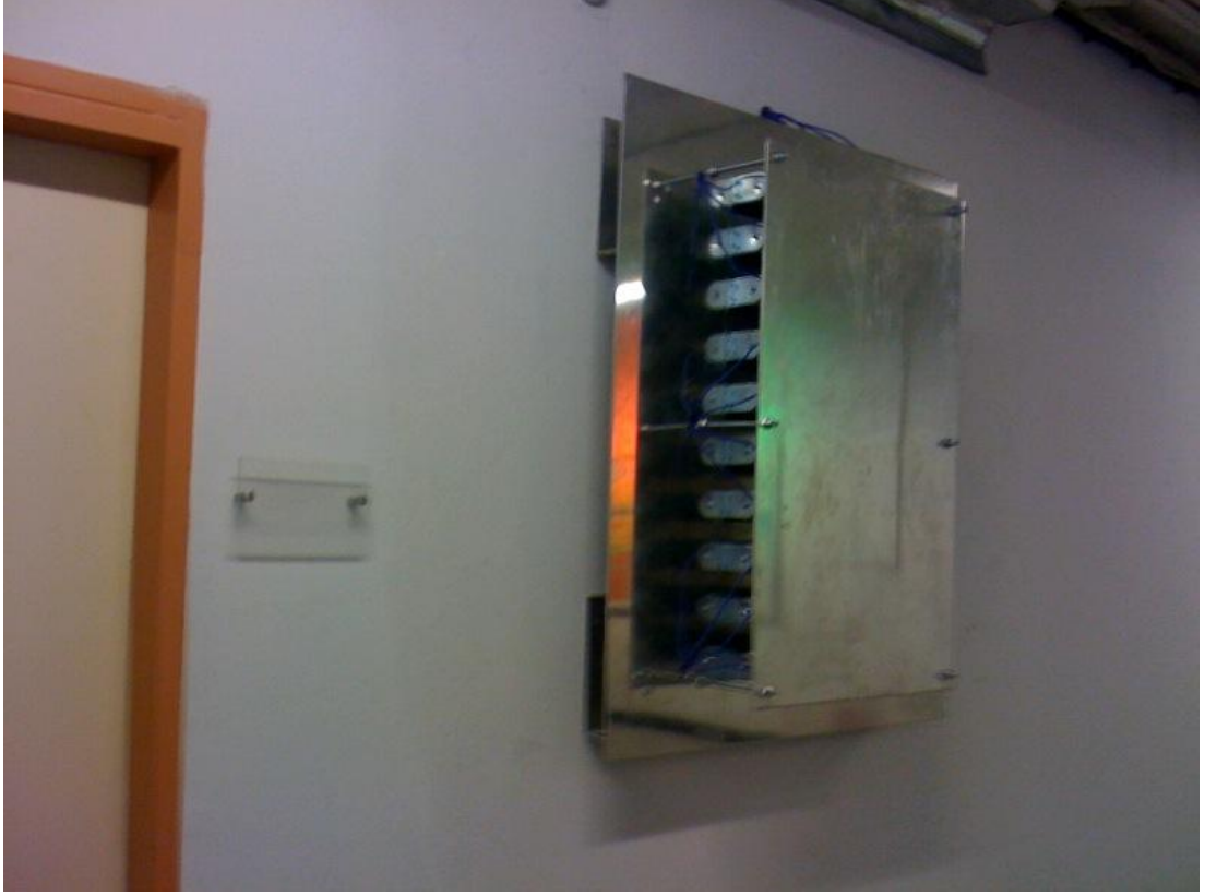
Şekil 3.6 : 5 kW Gücünde DC Yük Bankası
