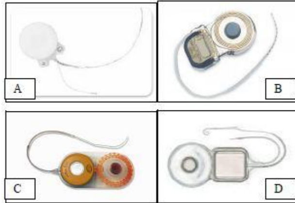
Resim 5. Farklı koklear implant modellerinin iç yapıları A. Digisonic, B. Med-el,C. Clarion, D. Nucleus
