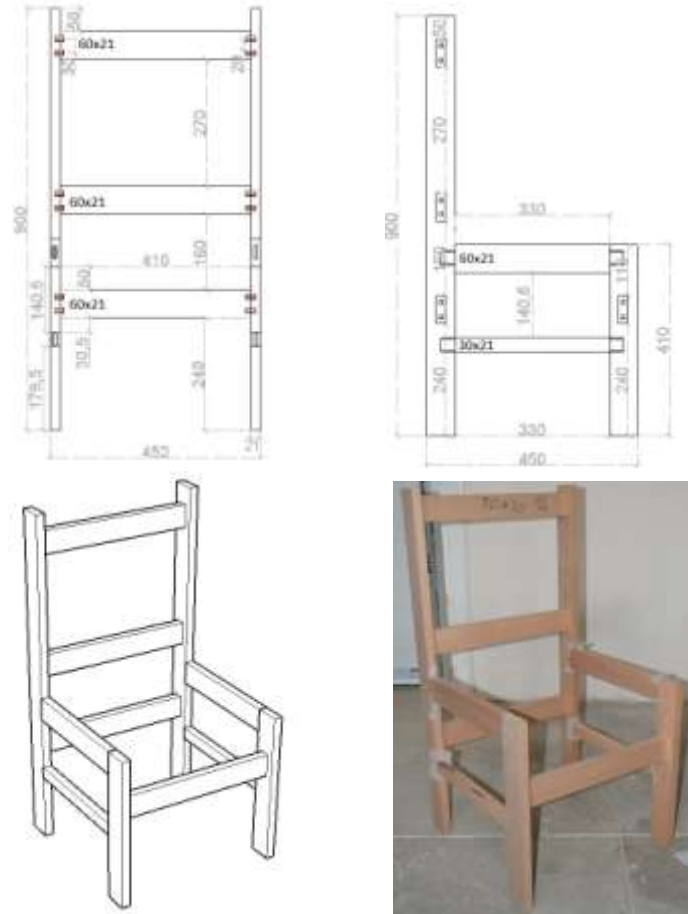
Şekil 3.10. Çalışmada kullanılan deney sandalyesinin ölçüleri ve görünüşü
