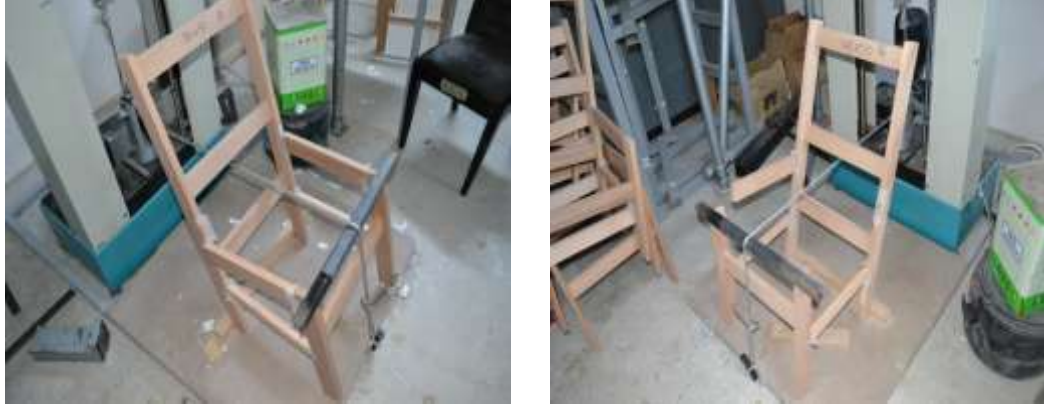
Şekil 4.3. Sandalye statik deneylerinde gözlenen ikinci deformasyon biçimi
