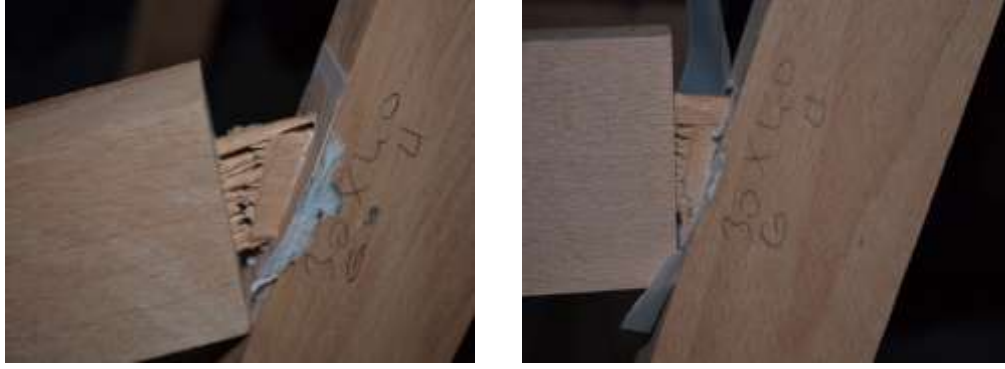
Şekil 4.7. Sandalye birleştirmelerindeki zıvanaların önce geri çıkıp daha sonra kesilerek kırılması
