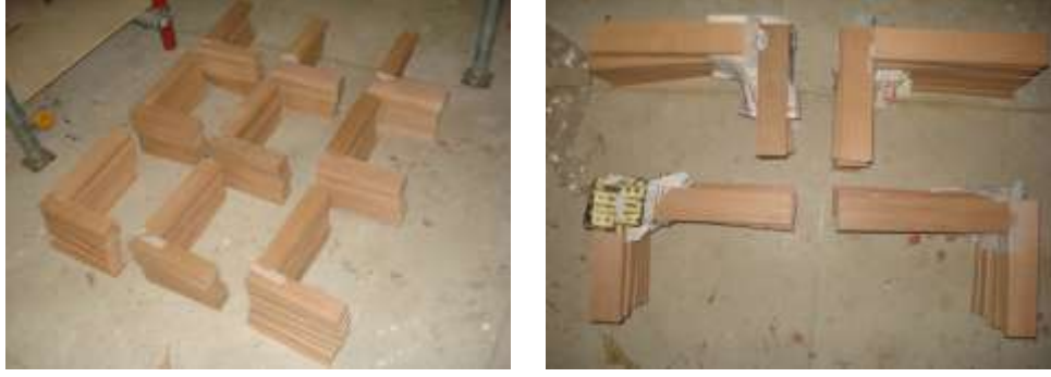
Şekil 3.8. Hazırlanan ve deney ortamında bekletilen L-tipi deney örnekleri
