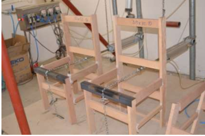
Şekil 3.18. Devirli önden arkaya yükleme testi düzenneđi
