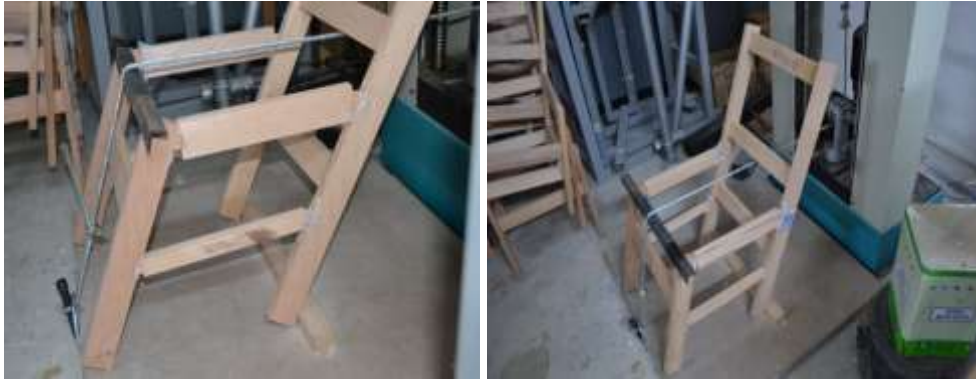
Şekil 4.6. Sandalye statik deneylerinde gözlenen ikinci deformasyon biçimi
