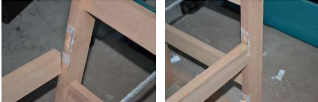
Şekil 4.4. Sandalye birleştirmelerindeki zıvanaların kesilerek kırılması
