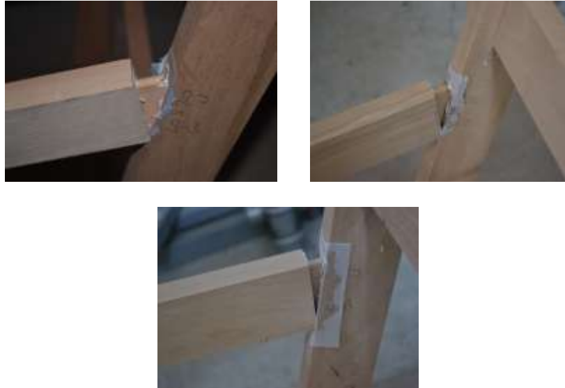
Şekil 4.2. Zıvanaların rotasyon yapacak şekilde yuvalarından çıkması
