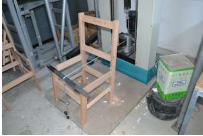
Şekil 3.16. Statik önden arkaya yükleme testi düzeneği
