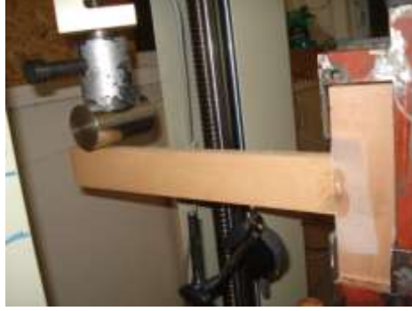
Şekil 3.13. T-tipi birleştirme elemanları eğilme deney düzeneği ve yük uygulama biçimi
