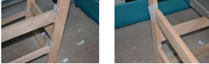
Şekil 4.1. Sandalye statik deneylerinde gözlenen birinci deformasyon biçimi
