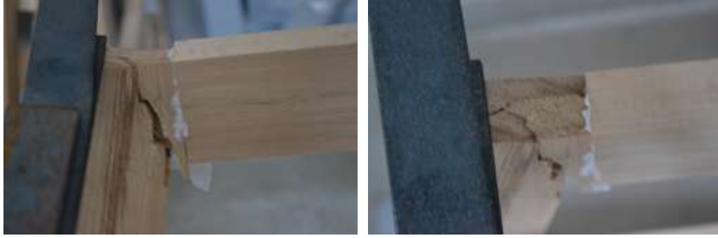
Şekil 4.5. Sandalye ön ayağın parçalanarak yarılması
