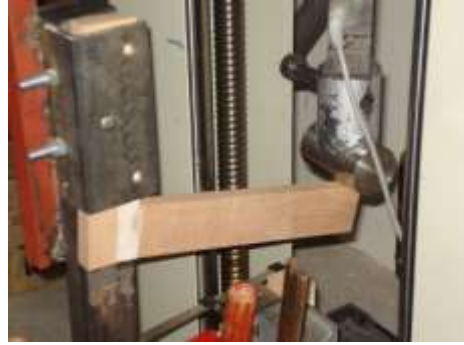
Şekil 3.14. L-tipi birleştirme elemanları eğilme deney düzeneği ve yük uygulama biçimi
