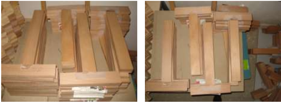
Şekil 3.7. Hazırlanan ve deney ortamında bekletilen T-tipi deney örnekleri
