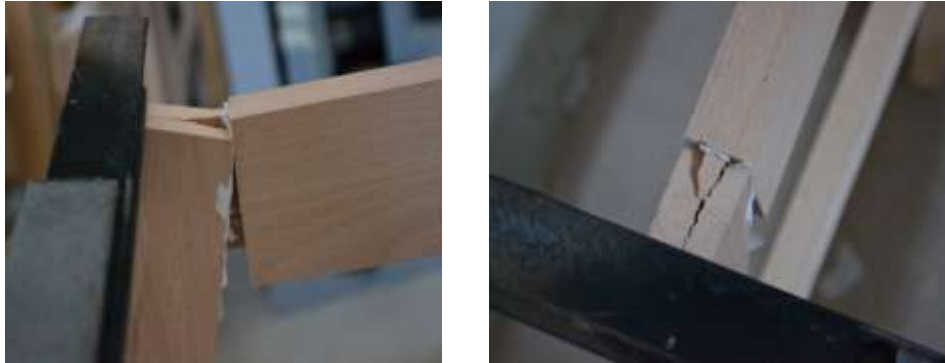
Şekil 4.8. Sandalye ön ayağın parçalanarak yarılmaması
