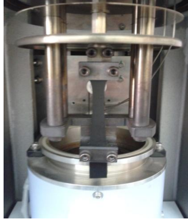
Şekil 3. 6 DMA cihazında karbon dolgulu COC'lerin mekanik analizi.
