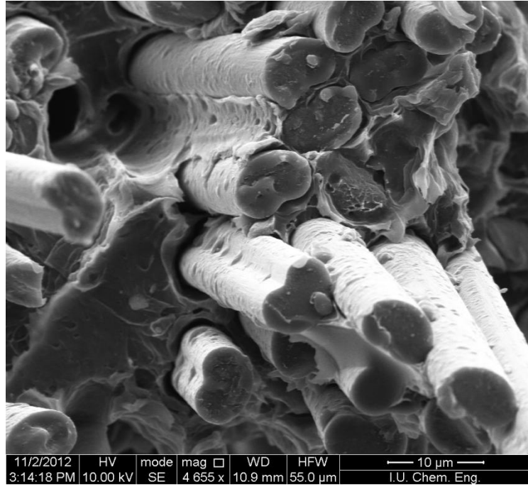
Şekil 4. 6 80 phr karbon elyaf içeren (CF80) kompozitin SEM görüntüleri.
