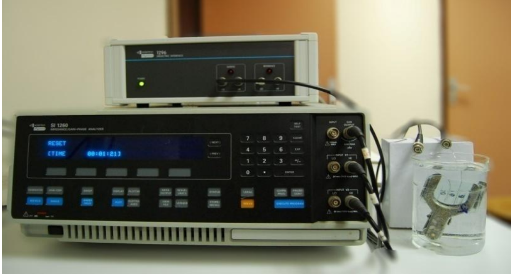
Şekil 3. 7 Solatron SI 1260 empedans analizörü ve Solatron 1296 Dielektrik arabirimi cihazı.
