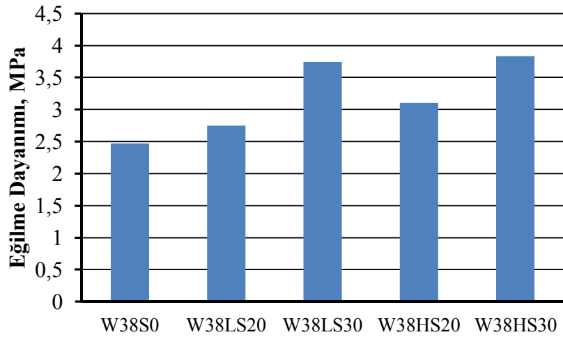
Şekil 5.9 : S/B oranı 0,38 olan numunelerin eğilme dayanımı sonuçları.
