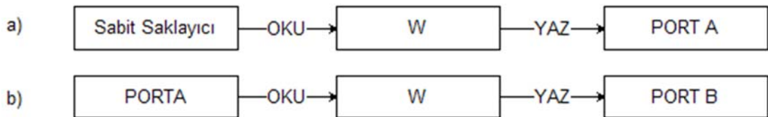
Şekil 4.4. W saklayıcısının işlevinin örneklerle gösterimi [10]
