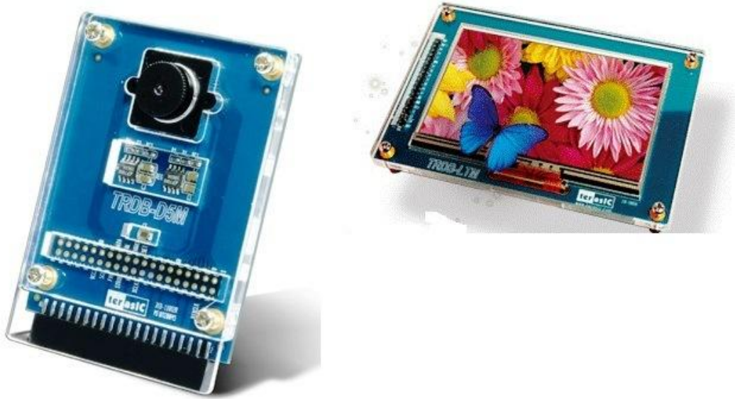
Şekil 3.7. D5M görüntü sensörü ve LTM LCD ekran
