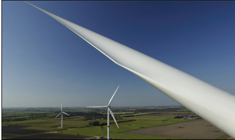
Şekil 3.16. Kanat süpürme alanının büyümesi enerjiyi de artırır
