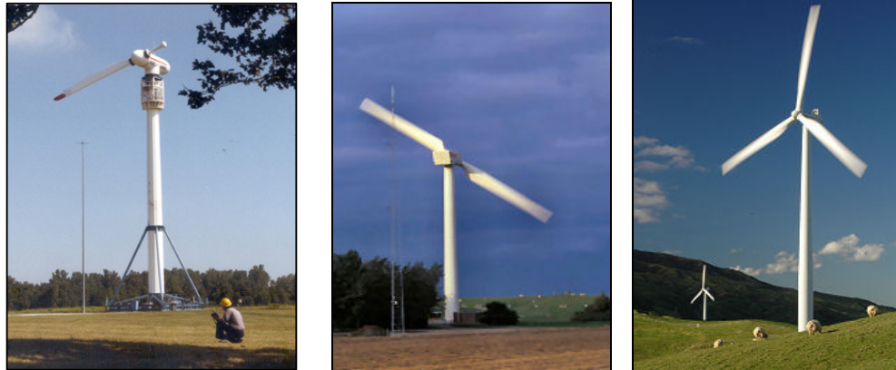
Şekil 3.14. Kanat sayısı etkisi
