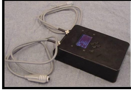
Şekil 1.10 : DragonFly uzaktan kontrol ünitesi.
