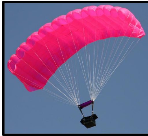
Şekil 1.14 : Kuzgun 150 kargo paraşüt sistemi (havada).
