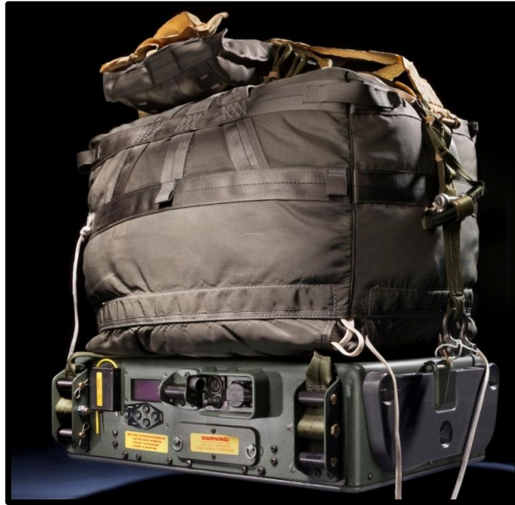
Şekil 3.1 : Örnek bir AGU ve çantalanmış paraşüt
