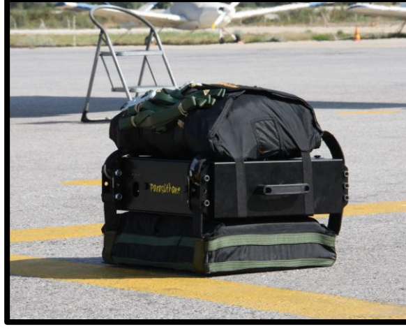
Şekil 1.15 : Kuzgun 150 kargo paraşüt sistemi (yerde).
