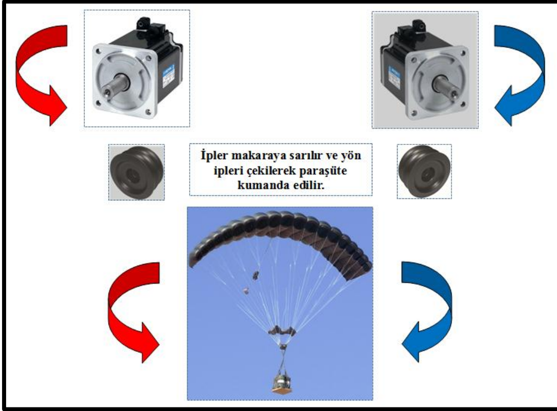
Şekil 3.7 : Makara sisteminin çalışması
