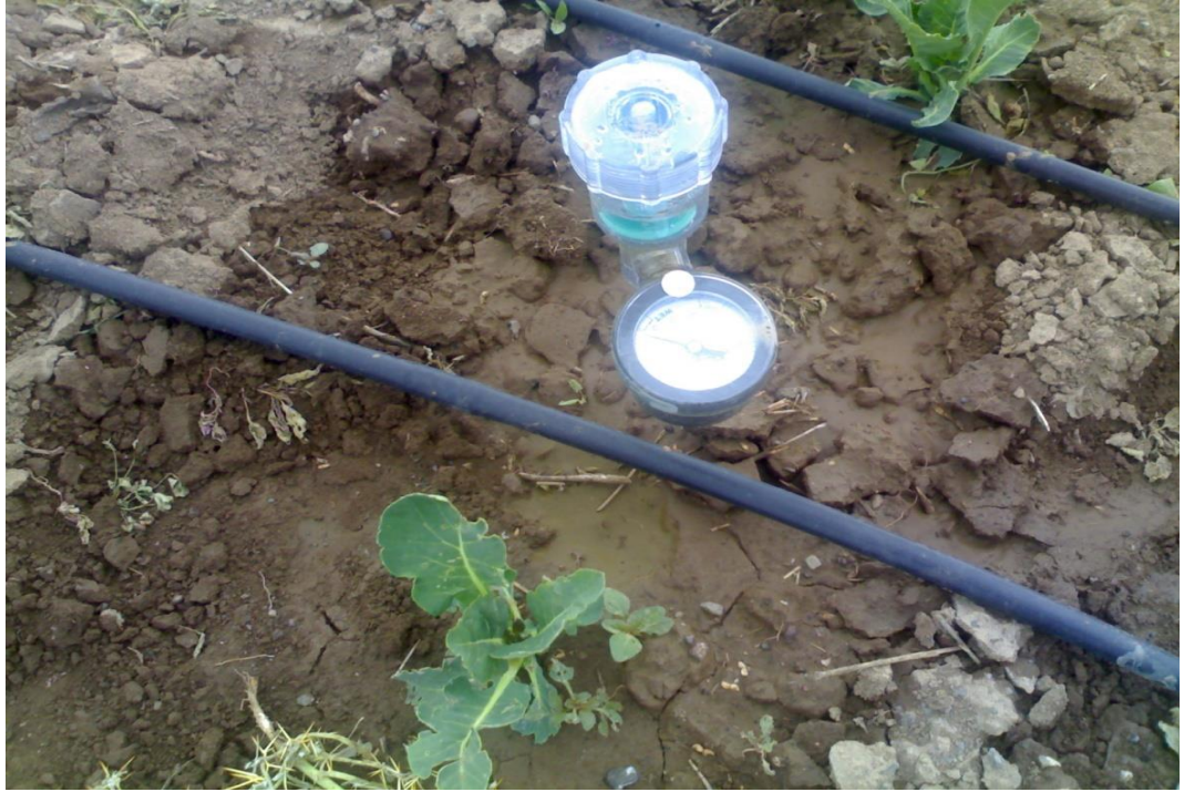
Şekil 3.6. Deneme parsellerinde konumlandırılmış bir manometreli tansiyometre
