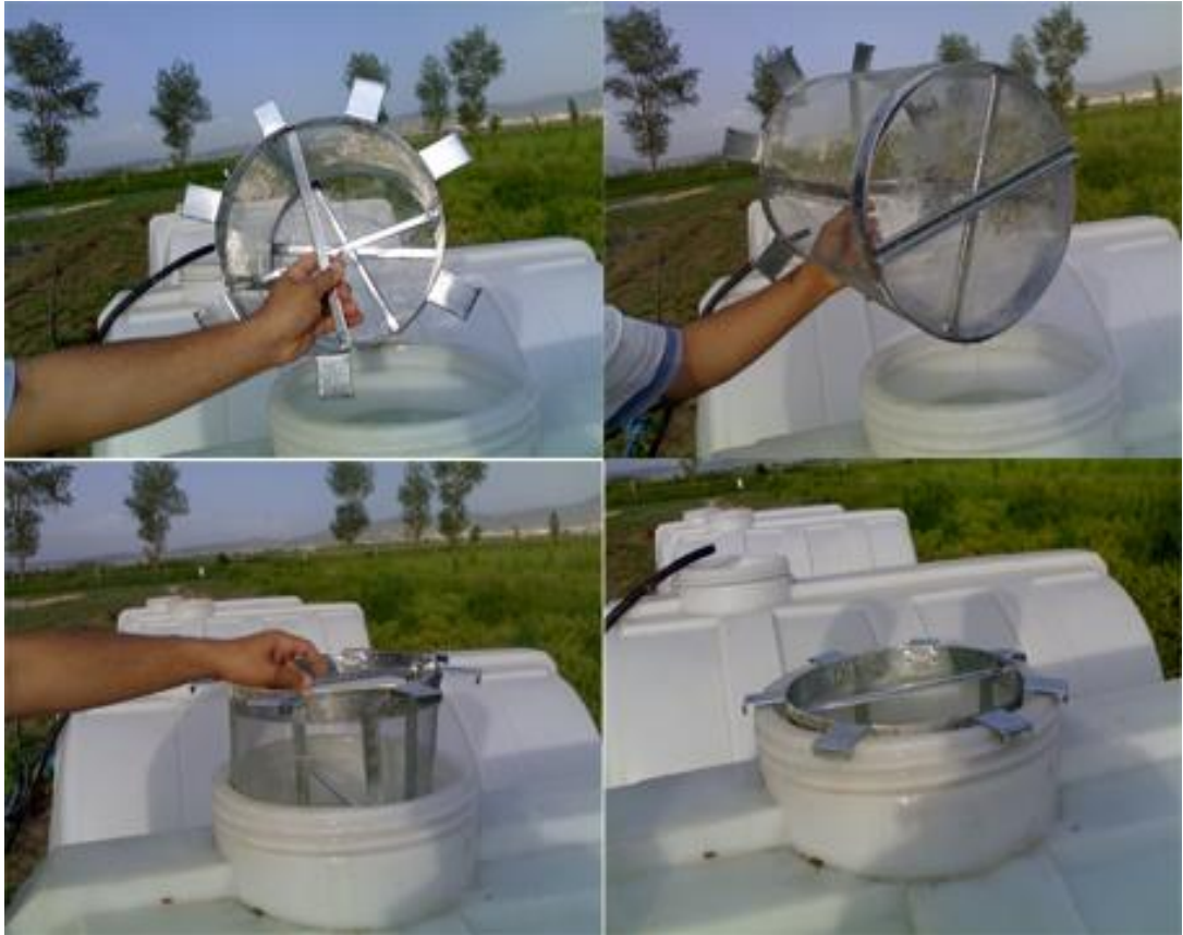
Şekil 3.3 Ön arıtım işleminin gerçekleştirildiği elek filtre
