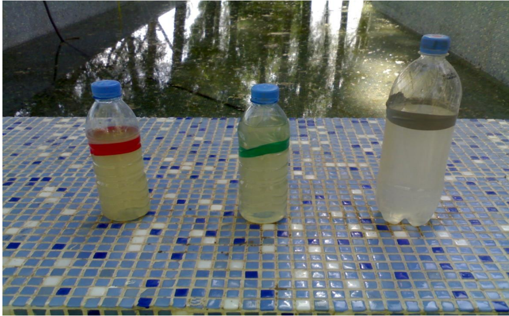
Şekil 3.4 Damlatıcı laterallerden analiz içi alınan, sulama amaçlı kullanılan filtre edilmiş atıksu, filtre edilmiş ve havalandırılmış atıksu ve filtre edilmiş 1:1 oranında temiz su ile seyreltilmiş atıksu
