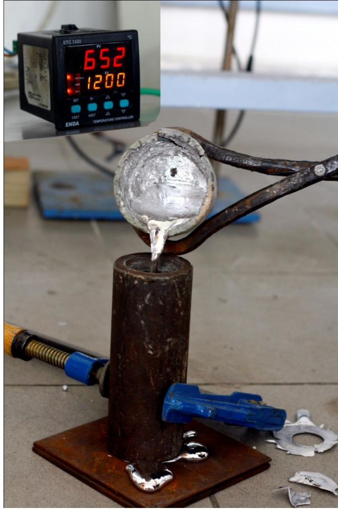
Şekil 9.4: Gravit dökümün yapılması
