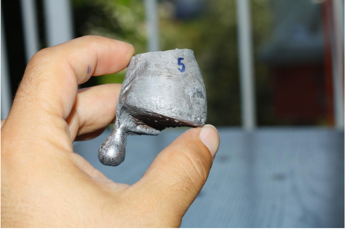
Şekil 9.7: Yarı katı sıcaklık aralığına ısıtılmış numune
