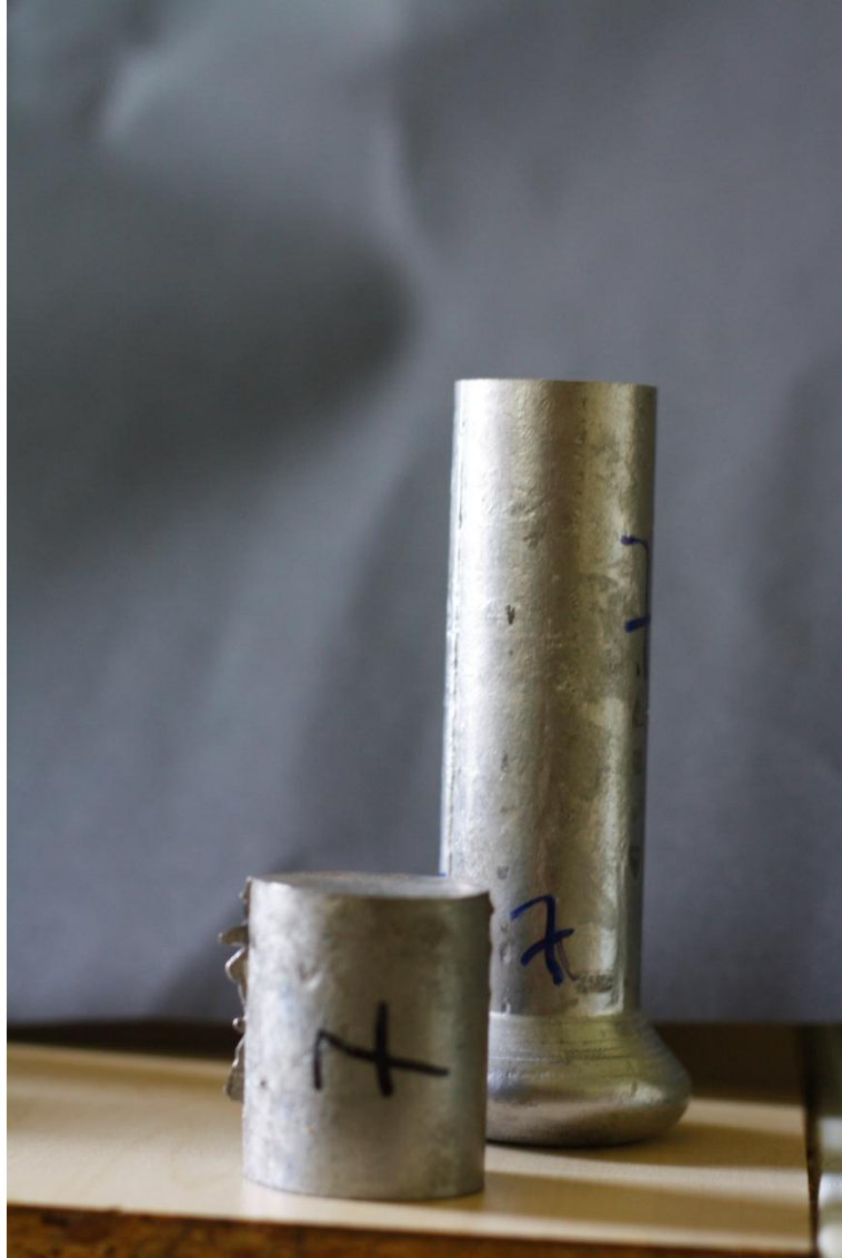
Şekil 9.5: Döküm sonrası numune ve soğuk deformasyon için kesilen numune
