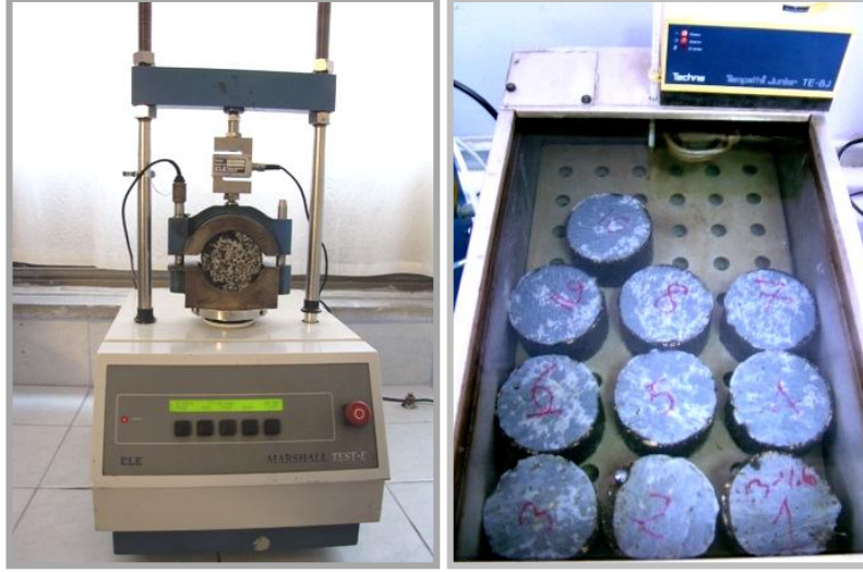
řekil 2.13. Marshall stabilite deney aleti ve deney numunelerinin su banyosunda bekletilmesi
