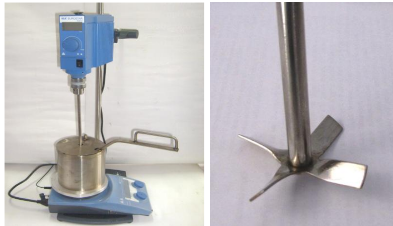
Şekil 4.1. Modifiye bağlayıcı hazırlama cihazı ve karıştırma aparatı
