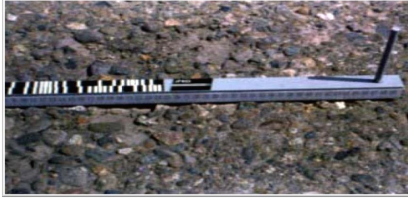
Şekil 2.40. Orta şiddette soyulma (İsfalt, 2002).
