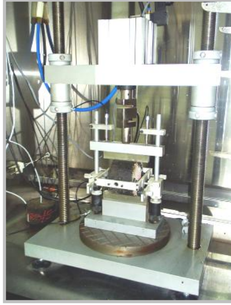
Şekil 2.17. İndirekt çekme tekrarlı yorulma deney düzeneği
