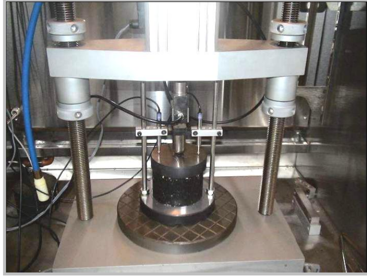
Şekil 2.20. Dinamik sünme deney düzeneği
