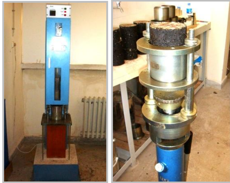
Şekil 2.11. Marshall stabilite sıkıştırma aleti ve numunelerin kalıptan çıkarılması
