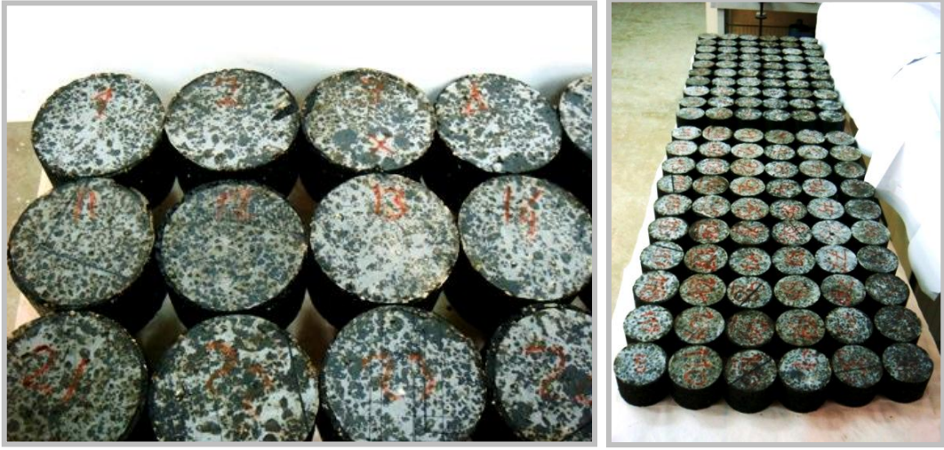
Şekil 2.12. Marshall stabilite deney numuneleri
