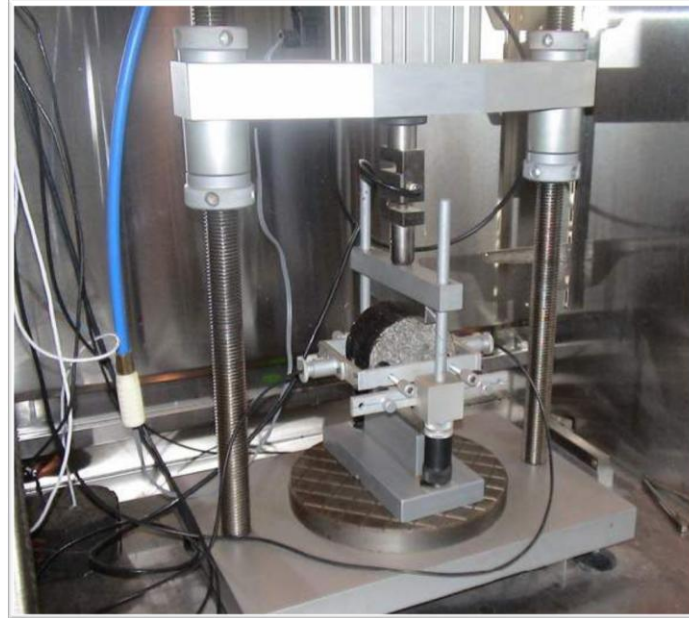
Şekil 2.16. İndirekt çekme rijitlik modülü deney düzeneği
