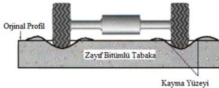
Şekil 2.27. Zayıf bitümlü tabakada tekerlek izi oluşumu (Geçkil, 2008).
