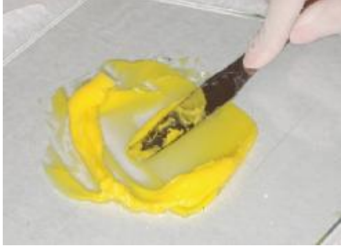
Şekil 3.7. Silikon elastomerlerin hazırlanışı
