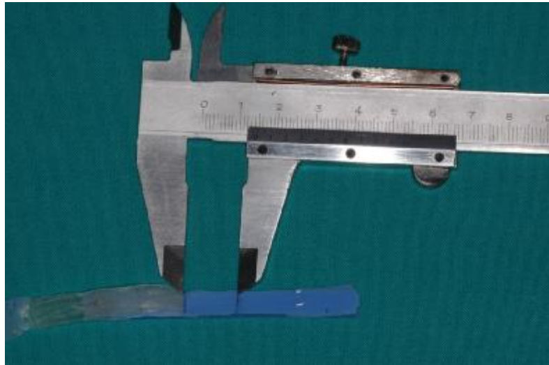
Şekil 3.13. Soyulma mesafesi ölçümü
