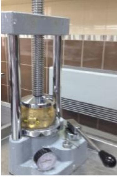
Şekil 3.9. Basınç altında preslenen mufla
