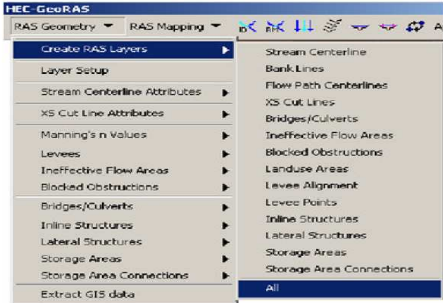
Şekil 3.11 Geometri menüsü ve elemanları (Merwade, 2010)
