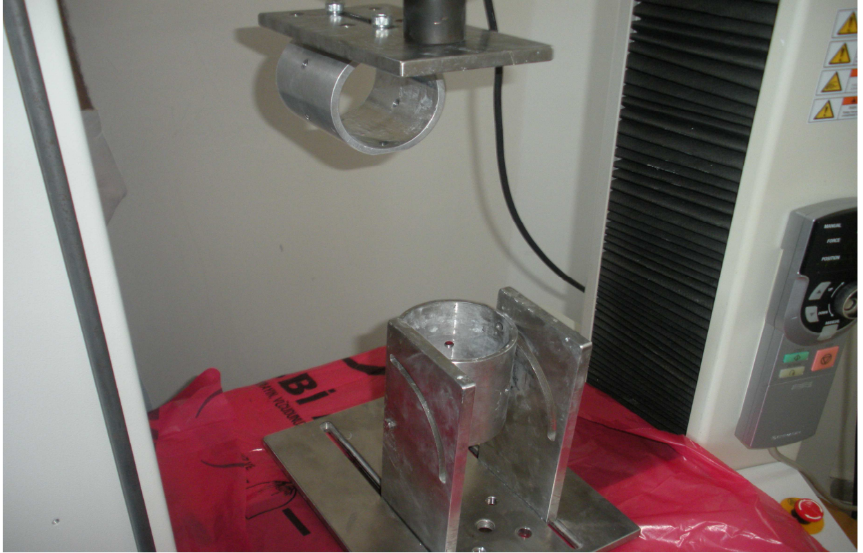
Şekil-47: ATT Testi İçin Düzenek Parçalarının Test Cihazına Takılması-2
