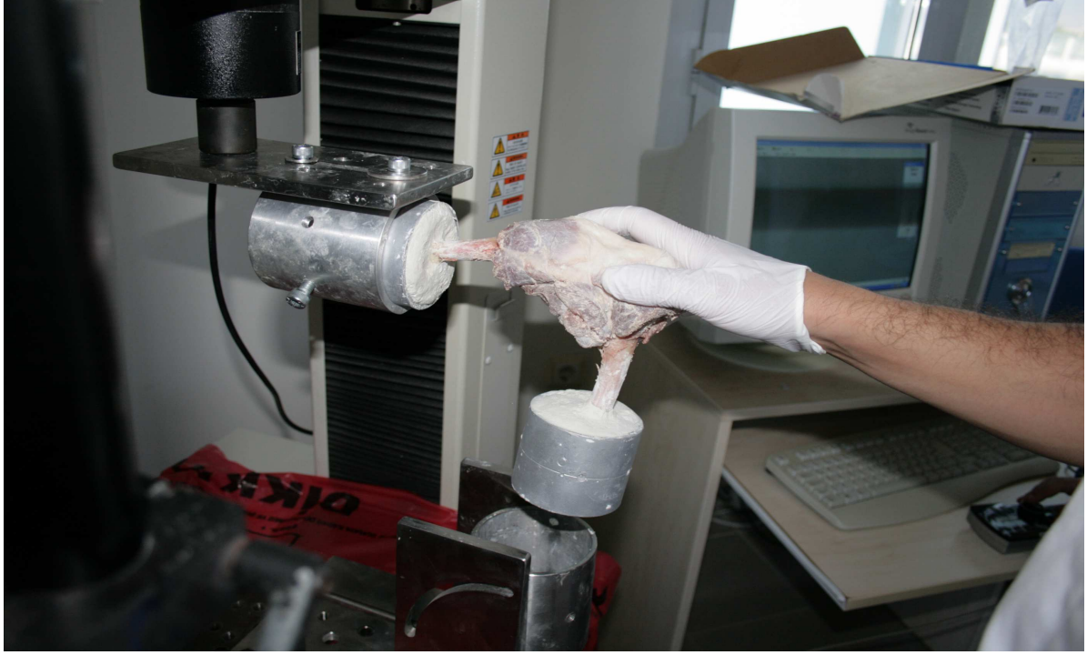
Şekil-48: ATT Testi İçin Örneklerin Test Cihazına Yerleştirilmesi-1
