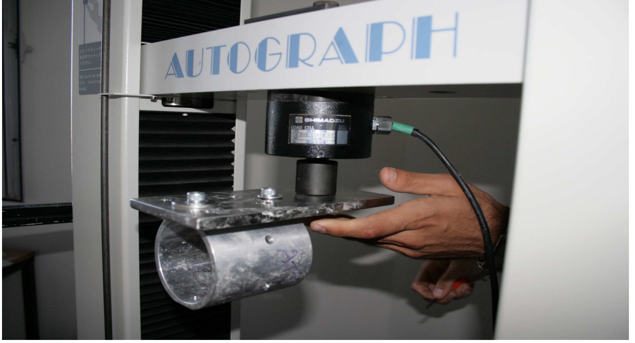
Şekil-46: ATT Testi İçin Düzenek Parçalarının Test Cihazına Takılması-1
