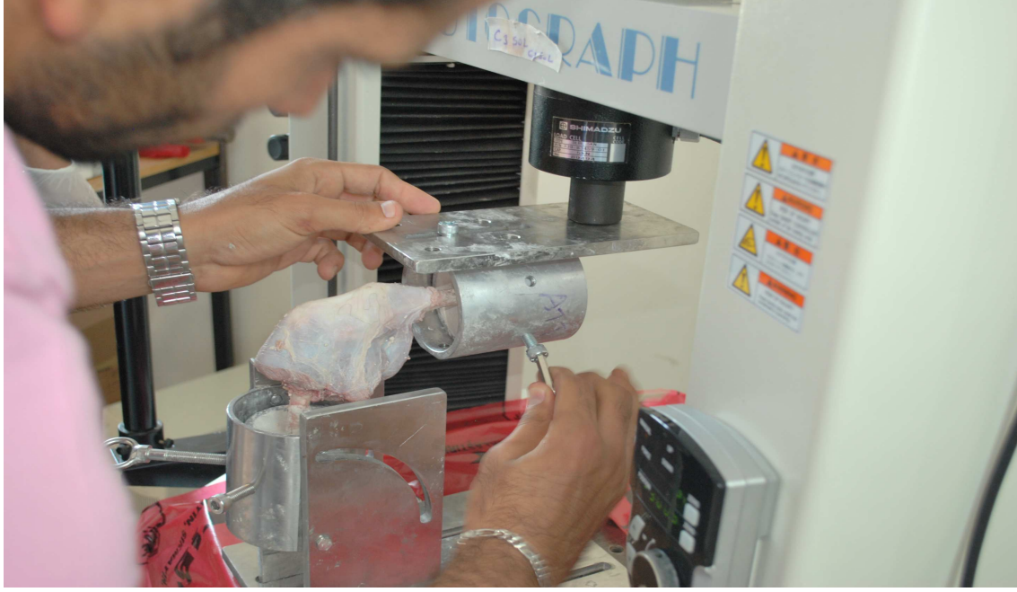
Şekil- 50: ATT Testi İçin Yerleştirilen Örneklerin Sabitlenmesi
