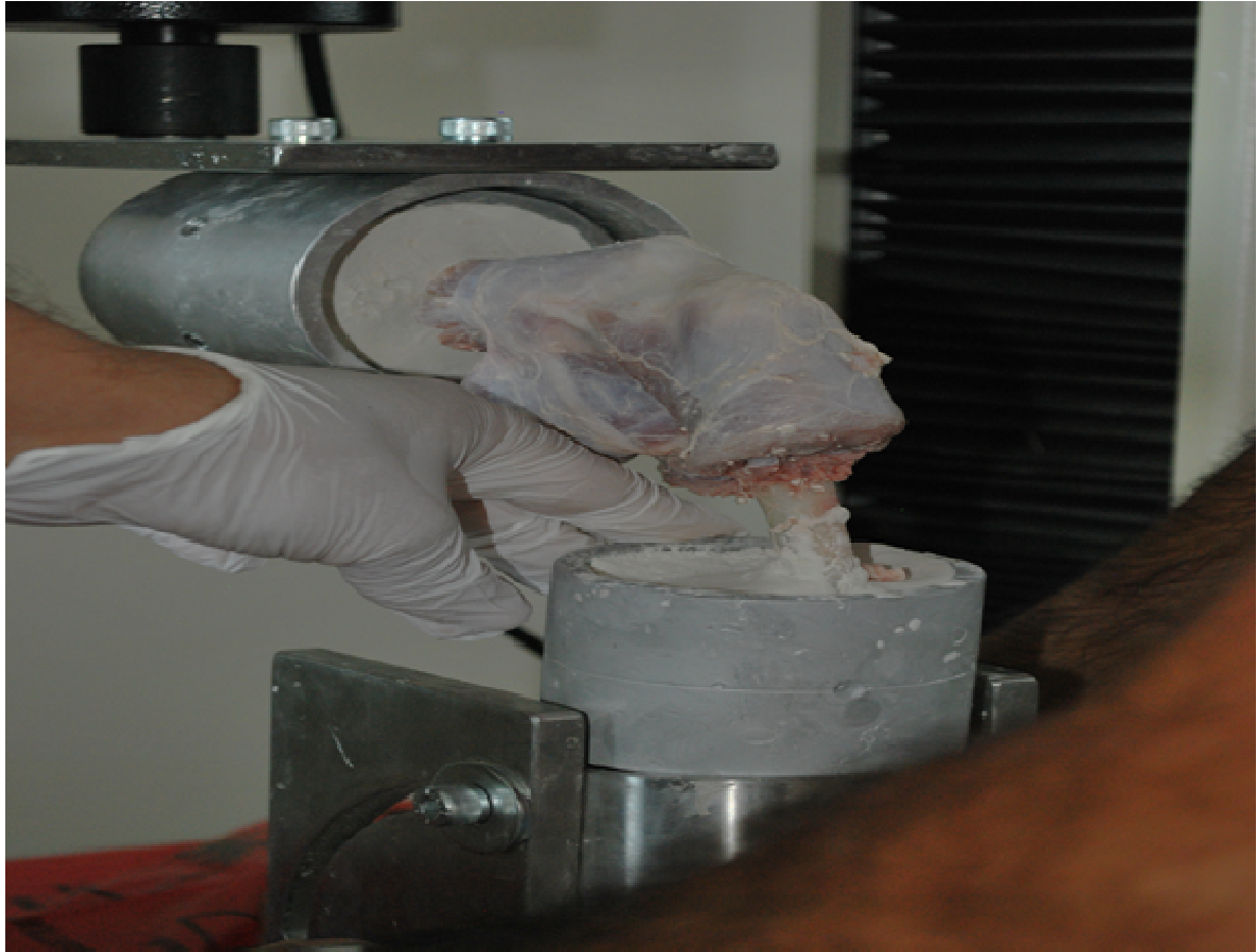
Şekil-49: ATT Testi İçin Örneklerin Test Cihazına Yerleştirilmesi-2
