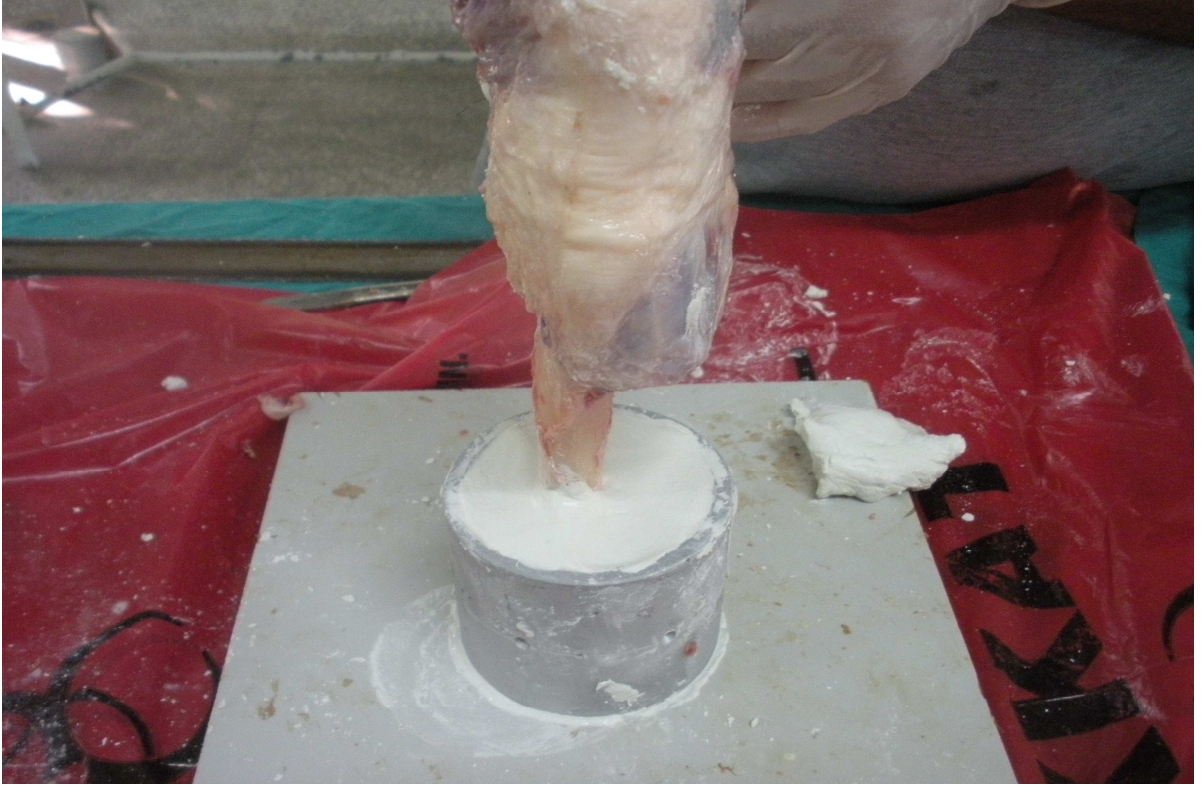
Şekil-42: Örneklerin Çimento ile Metal Silindirlere Yerleştirilmesi
