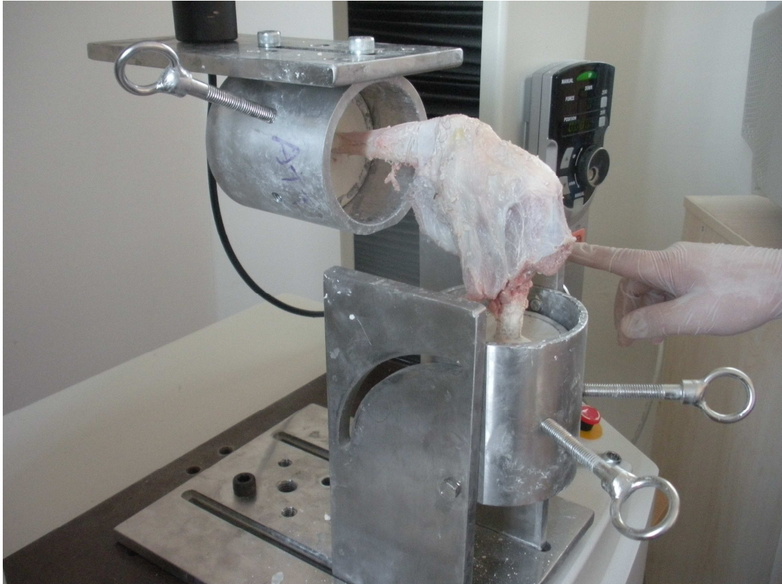
Şekil-51: ATT Testi için Hazırlığın Tamamlanması: Örnekler Test Cihazına Tibia Üstte Olacak Şekilde 90 derece Fleksiyonda Yerleştirip Sabitlendi. Test Parametrelerinin (sıklus-yük-hız) Ayarlanması
