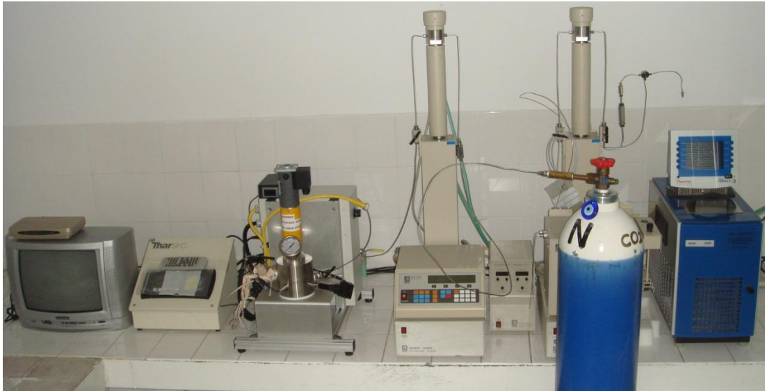
Şekil 3.4 Safır cam pencereli ve mekanik karıştırırmalı yüksek basınç reaktör sistemi
