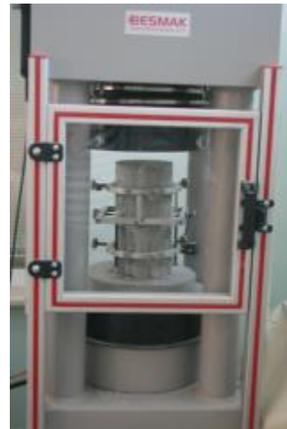
Şekil 3.11. Hidrolik pres aletinde beton numunenin kırılması
