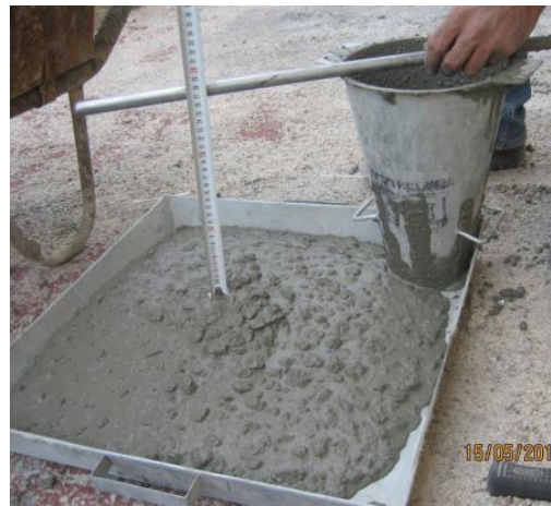
Şekil 6.13. 6.Grup beton karışımı slump deneyi
