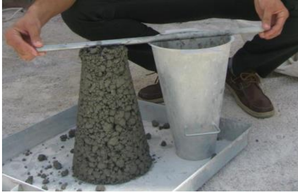
Şekil 6.8. 1.Grup beton karışımı slump deneyi
