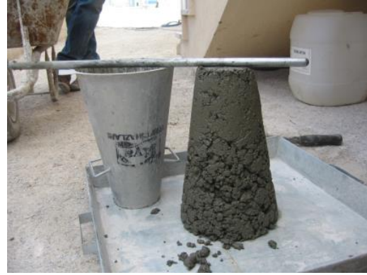
Şekil 6.9. 2.Grup beton karışımı slump deneyi
