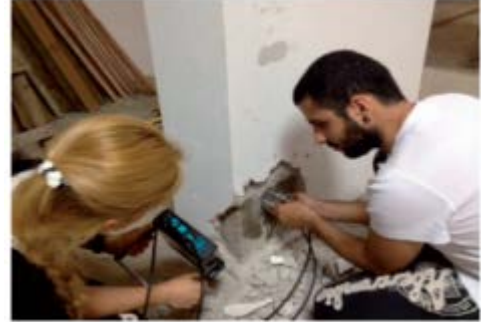
Şekil 3.7. Sıvalı bir kolonda ölçüm alma işlemi (Özçep ve ark., 2012)
