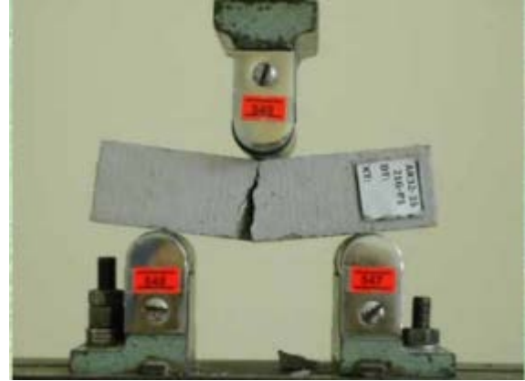
Şekil 3.10. 3 noktada eğilme deneyi (Ün, 2007)
