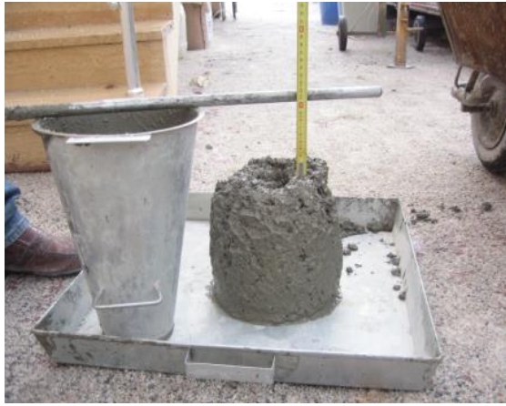
Şekil 6.10. 3.Grup beton karışımı slump deneyi
