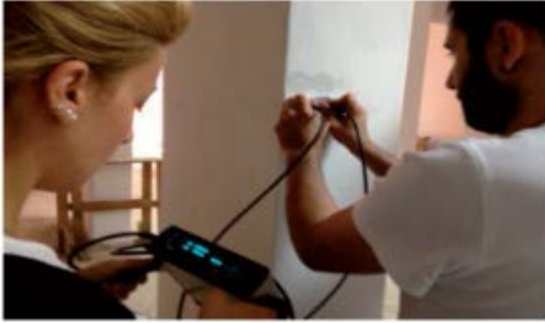
Şekil 3.6. Sıvasız bir kolonda ölçüm alma işlemi (Özçep ve ark., 2012)
