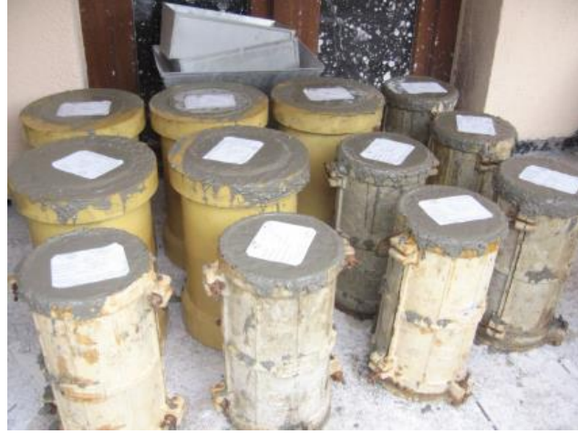
Şekil 6.19. Prizlerini almak üzere bekletilen beton numuneler
