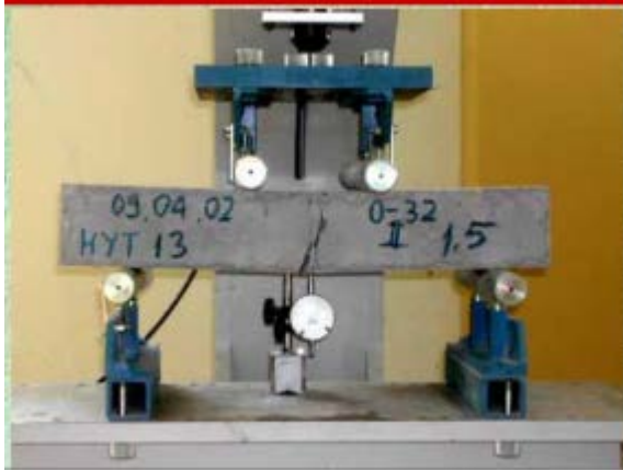
Şekil 3.9. 4 noktada eğilme deneyi (Ün, 2007)
