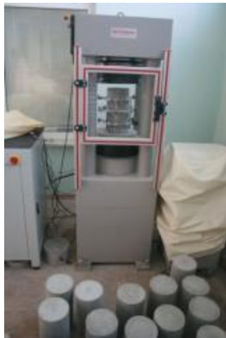
Şekil 3.11. Hidrolik pres aletinde beton numunenin kırılması
