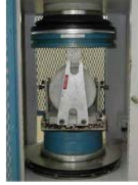
Şekil 3.8. Yarmada çekme dayanım deneyi (Ün, 2007)
