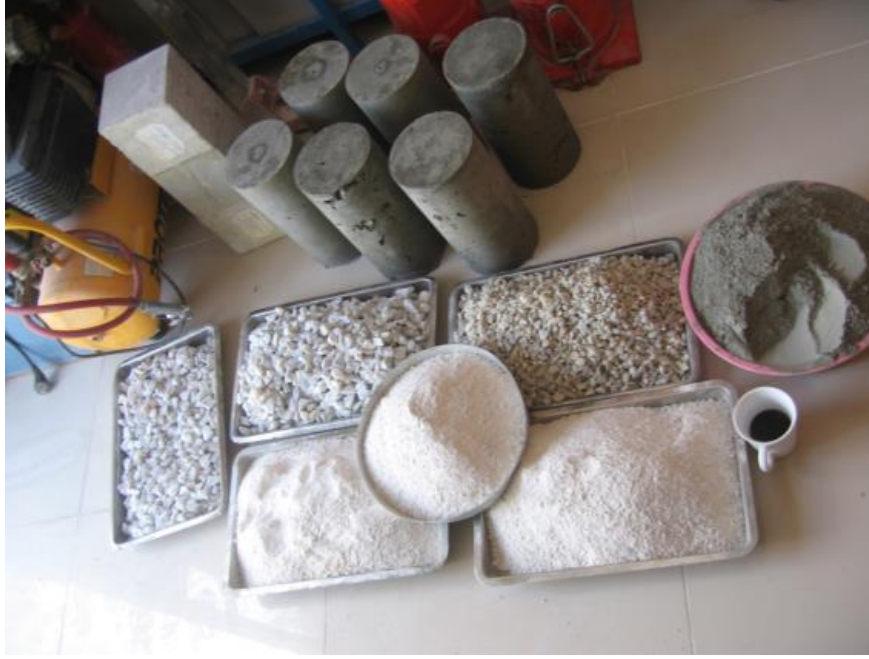
Şekil 6.5. Beton karışım için tartılan malzemeler
