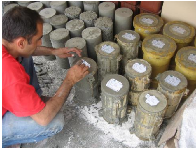
Şekil 6.18. Beton numunelerin etiketlenmesi
