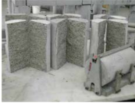
Şekil 3.8. Yarmada çekme dayanım deneyi (Ün, 2007)
