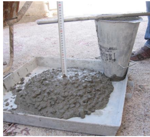
Şekil 6.11. 4.Grup beton karışımı slump deneyi
