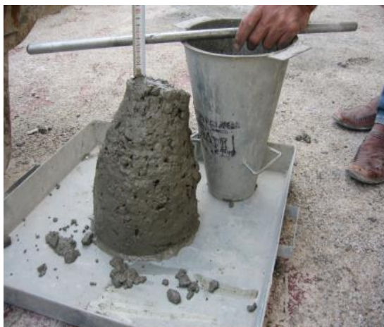
Şekil 6.12. 5.Grup beton karışımı slump deneyi
