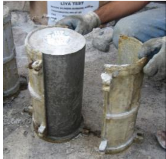
Şekil 6.21. Betonun kalıptan alınması
