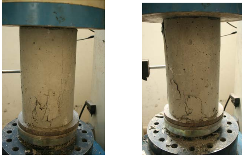
Şekil 6.42. Yükleme sonucu beton numunelerde oluşan deformasyonlar
