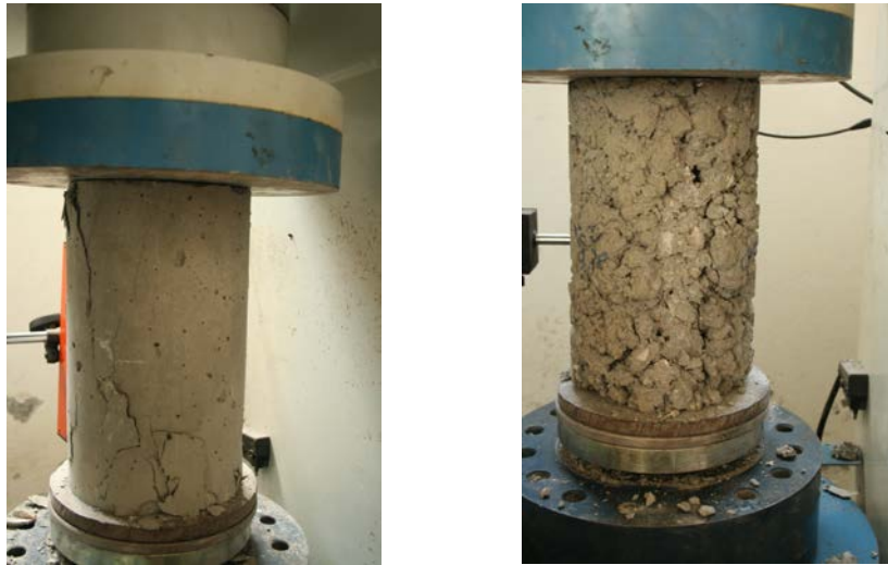
Şekil 6.43. Yükleme sonucu beton numunelerde oluşan deformasyonlar
