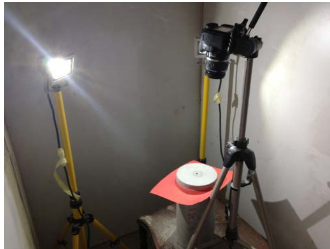
Şekil 6.26. Kabin içinde görüntülenenen beton numunesi
