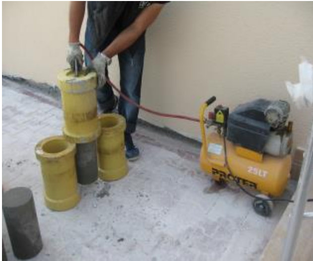
Şekil 6.20. Betonun kompresör ile kalıptan alınması
