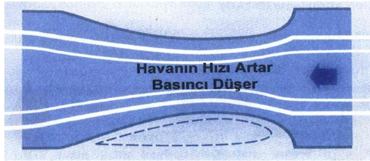
Şekil 3.11: Kanat profilinin üst kısmının venturi tüpüne benzerliği (Açan ve diğerleri, 2008).
