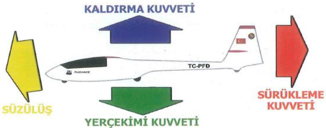
Şekil 3.10: Planöre etki eden kuvvetler (Açan ve diğerleri, 2008)
