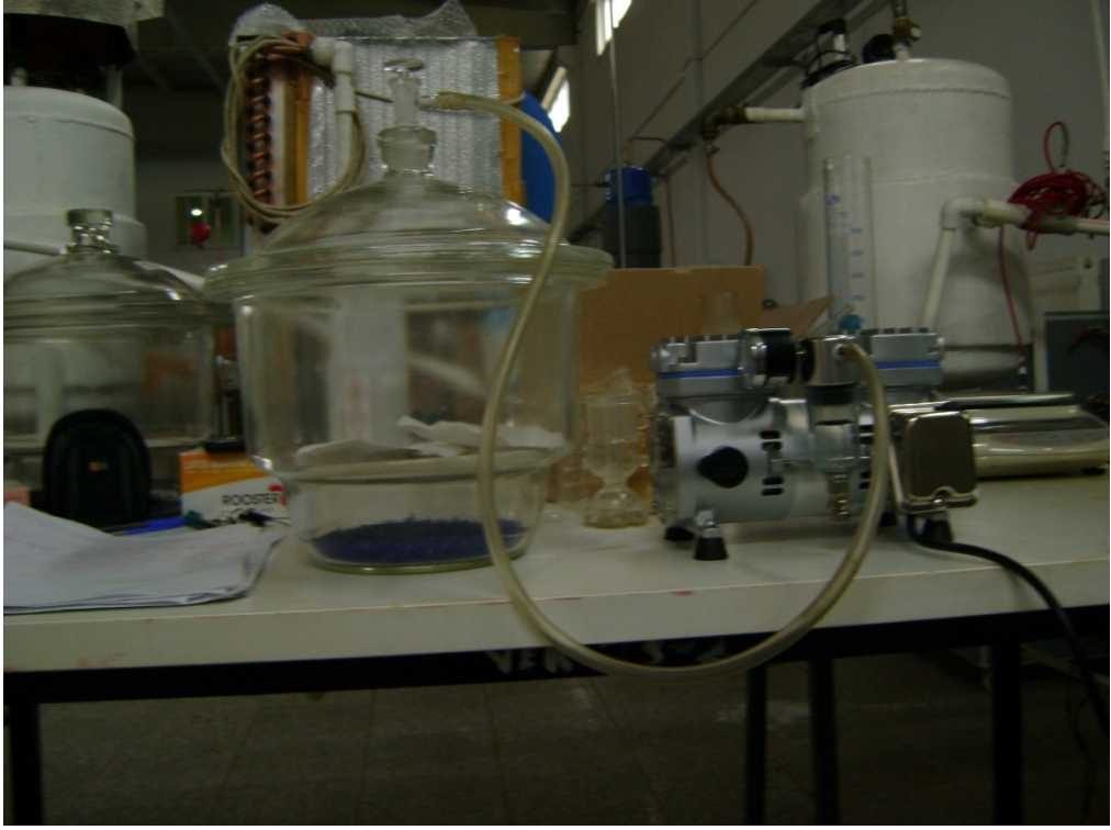
Şekil 3.18. DA-NTDA polimerinin üretimi (vakumlu desikatörde bekletme işlemi)
