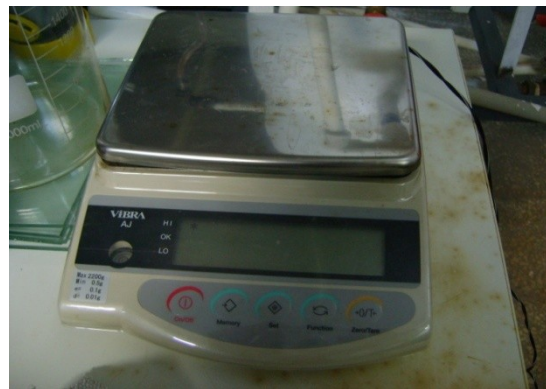
Şekil 3.2. Vibra Aj hassas terazi (Yekarum laboratuvarı)
