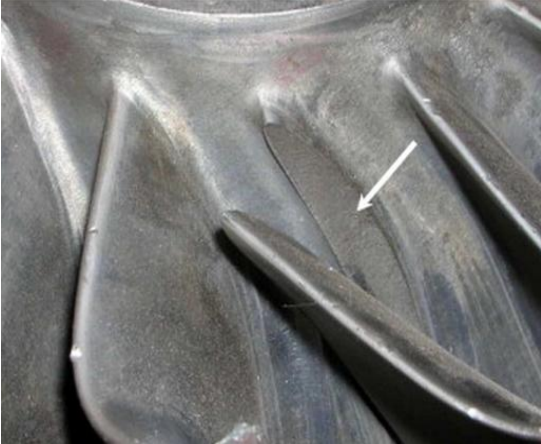
Şekil 3.53 : Kanat hasarı detay görünümü.
