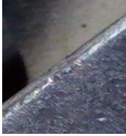
Şekil 3.44 : İmpeller kanat üzerinde takım izleri.
