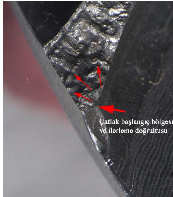
Şekil 3.47 : İmpeller kanat üzerinde çatlak görünümü.
