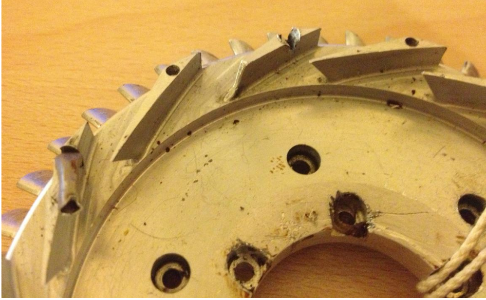
Şekil 3.16 : Hasara uğramış difüzör.
