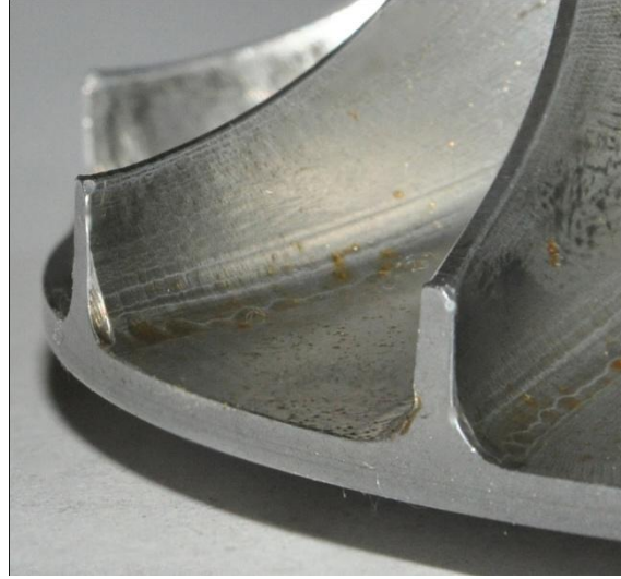
Şekil 3.46 : İmpeller kanat üzerinde takım izleri.
