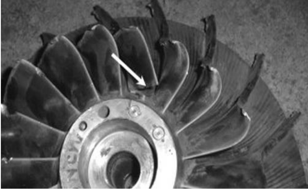
Şekil 3.52 : Örnek bir impeller üzerinde çatlak görünümü.
