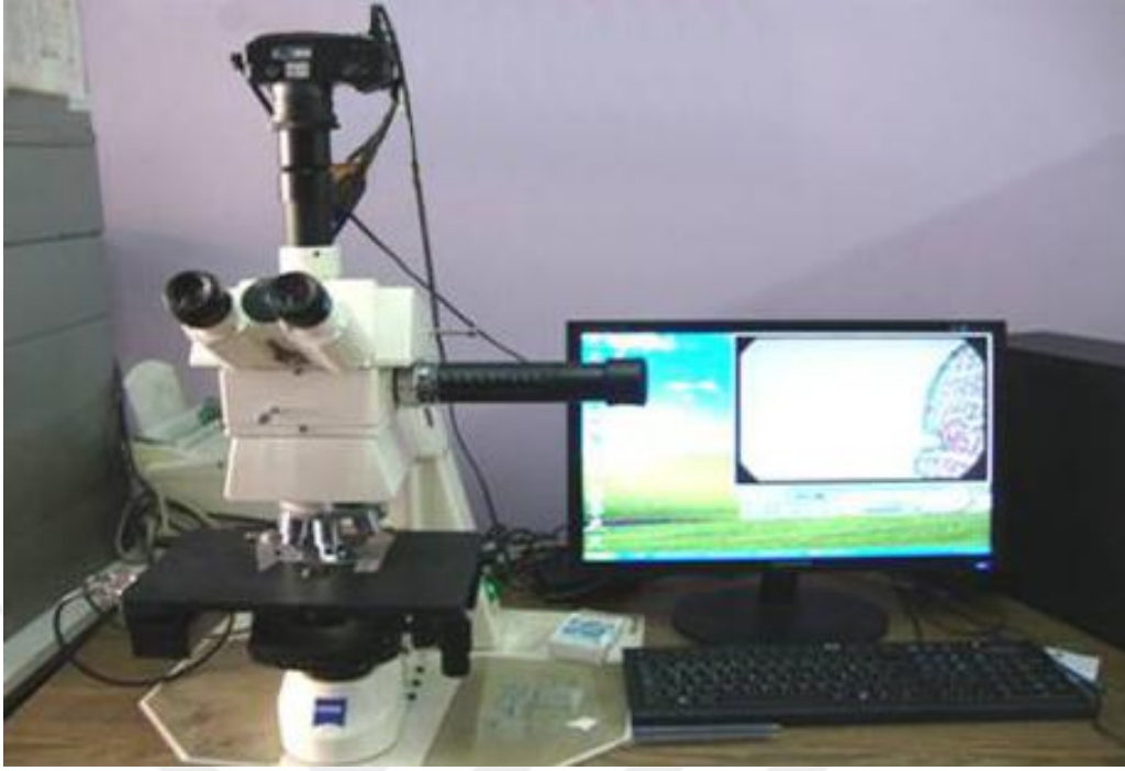
Şekil 15. Sayımda kullanılan fotoğraf ataşmanı ilave edilmiş mikroskop ( Zeiss Axioskop 4 Carl Zeis Göttingen Germany)
