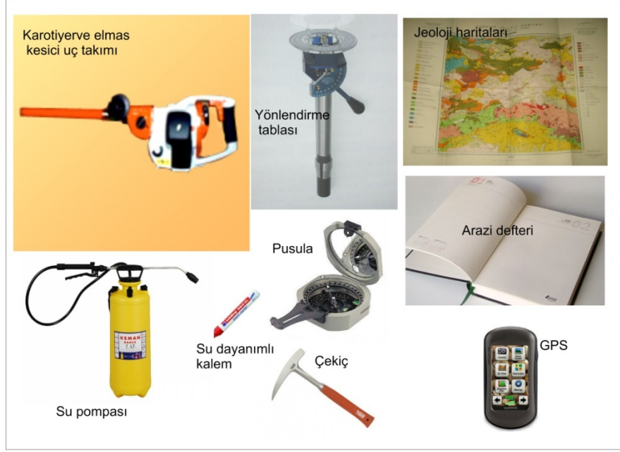
Şekil 3.6: Paleomağnetik çalışmalarda kullanılan standart arazi ekipmanı.
