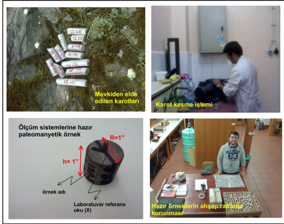
Şekil 3.8: Karotların kesilerek ölçüm sistemlerine hazır örneklerin elde edilmesi.
