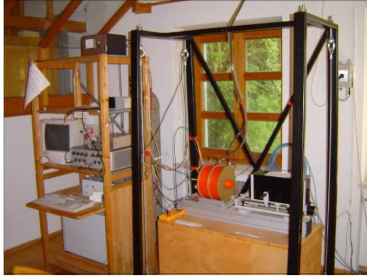
Şekil 3.37: Deđişken alan çevrim terazisi ölçüm sistemi.
