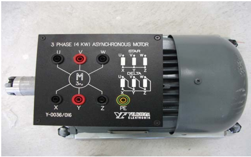
Resim 3.1. 3 Fazlı 4 kW sincap kafesli bir asenkron makina.
