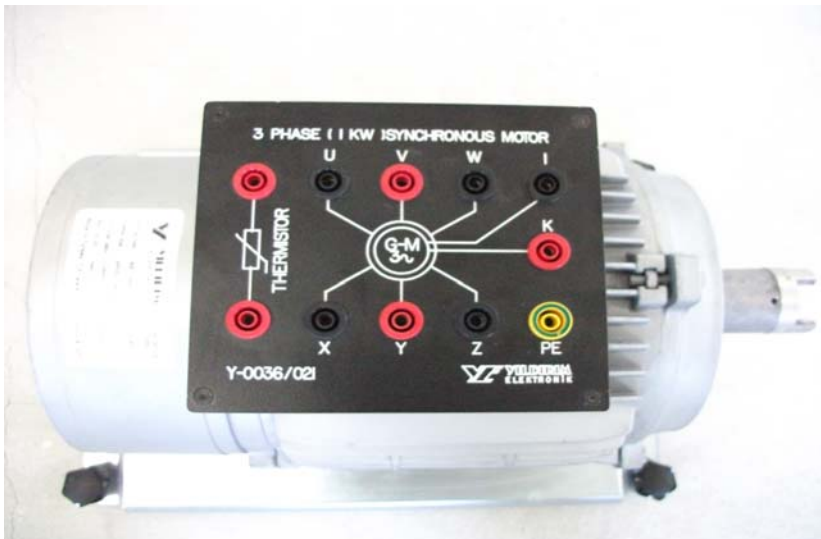
Resim 3.2. 3 Fazlı 1 kW rotorlu sargılı senkron makina.
