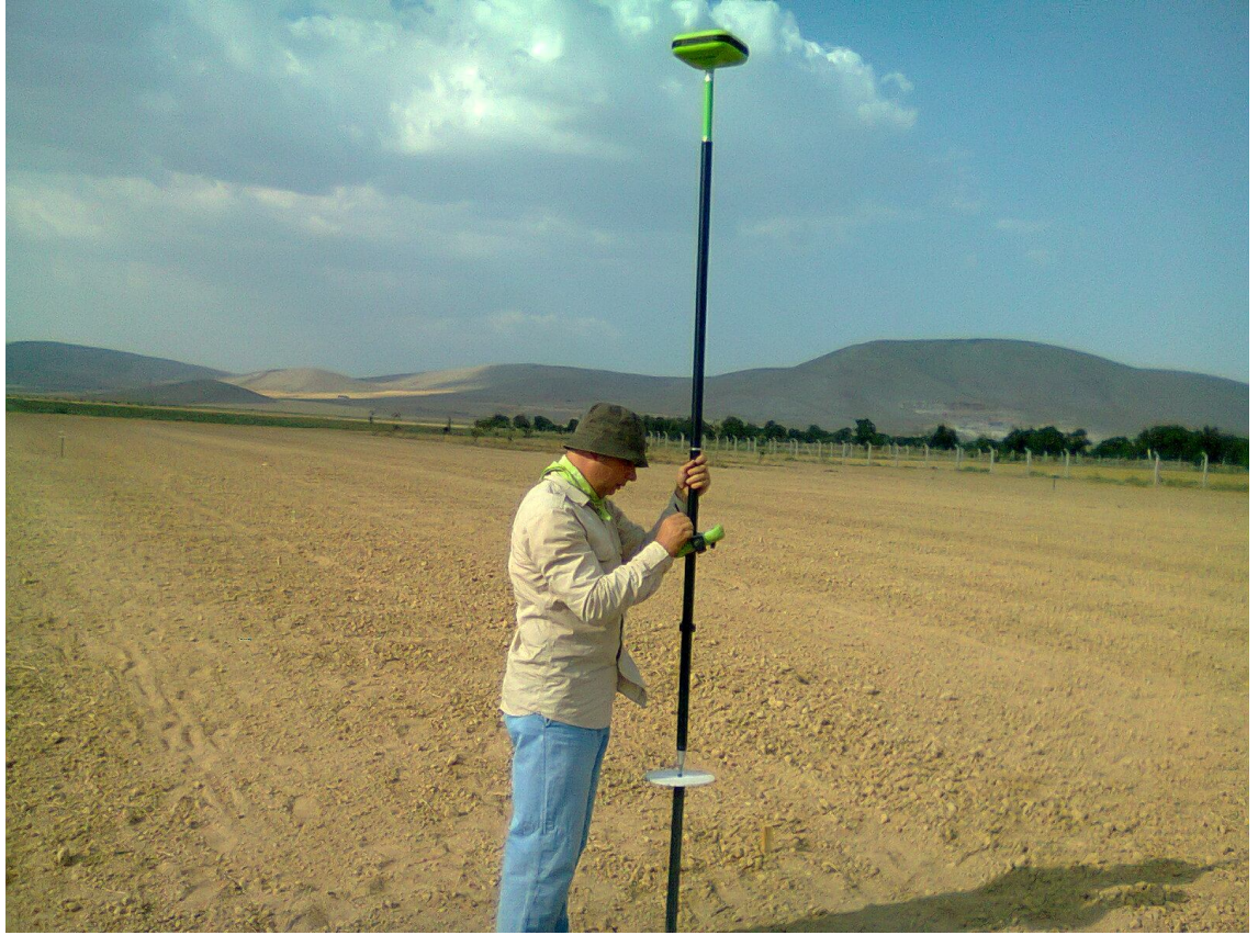
Şekil 3.15. Gezici GPS aleti ile noktaların koordinatlandırılması
