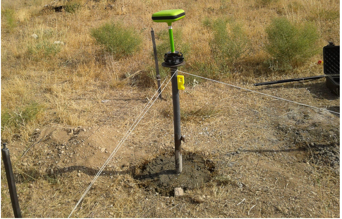
Şekil 3.13. Sarıcalar çalışma alanında tesis edilen sabit istasyon
