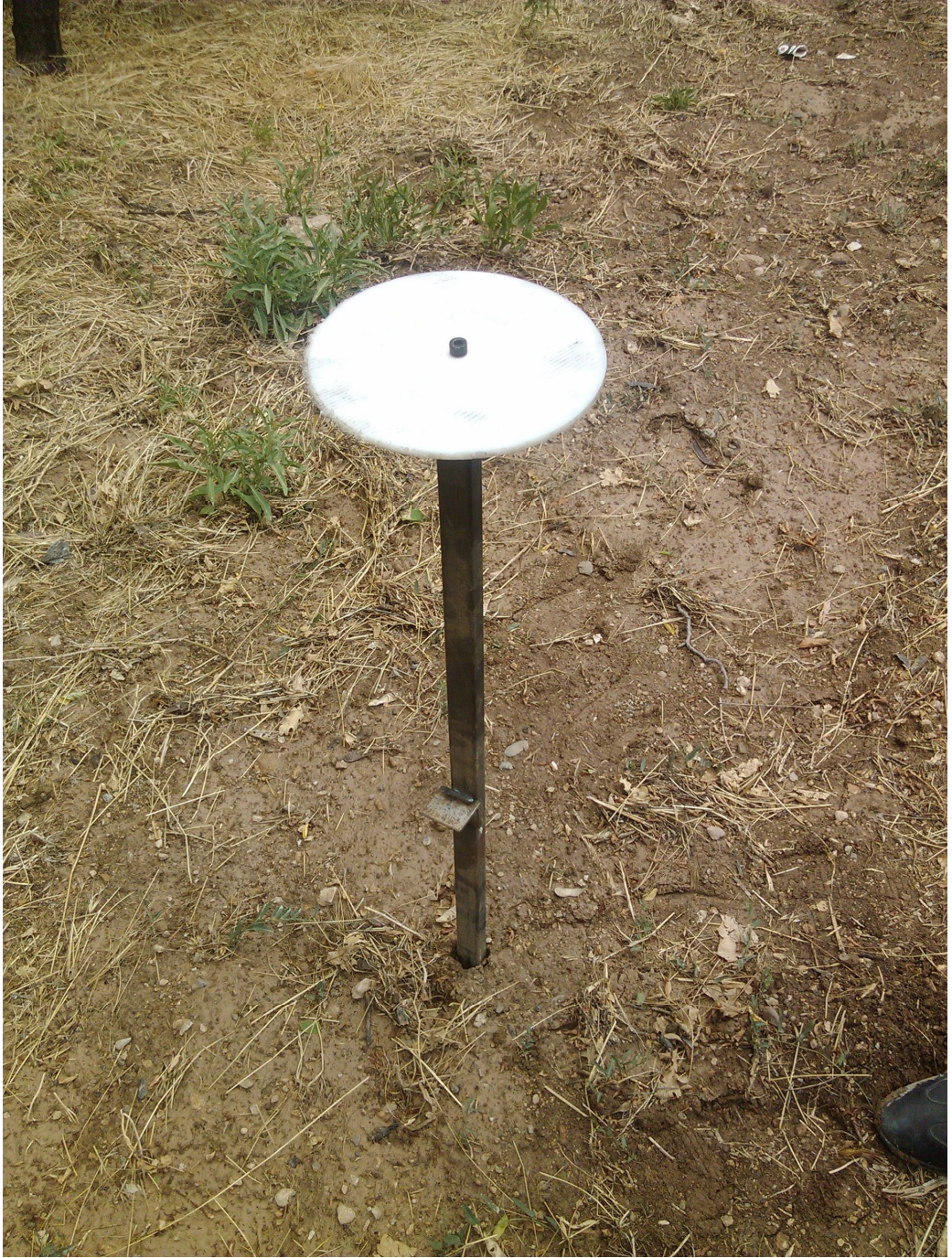
Şekil 3.10. Teflon plakanın arazide kurulu hali
