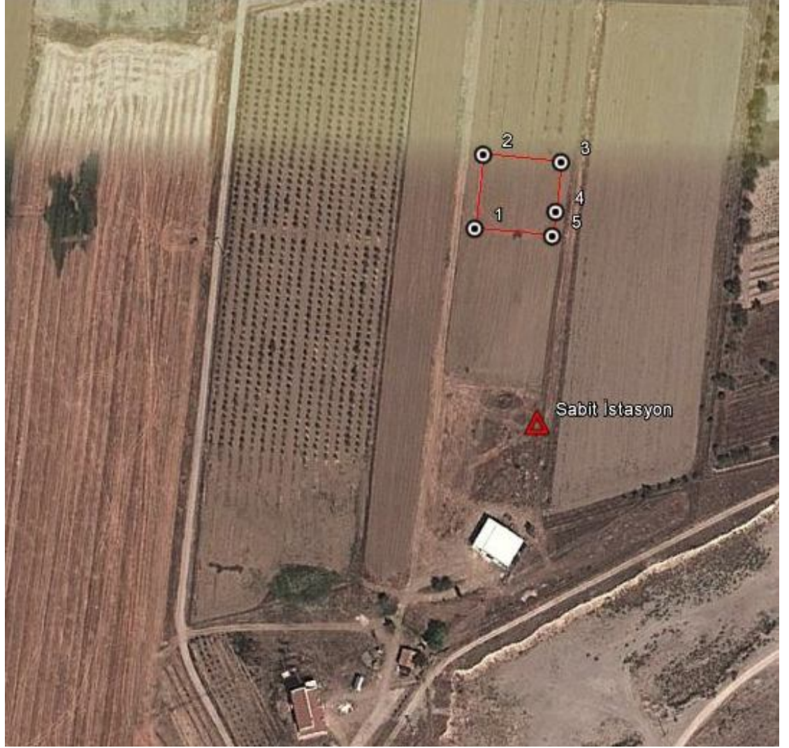
Şekil 3.14. Sarıcalar çalışma alanında RTK yöntemi ile tesis edilen 5 nokta
