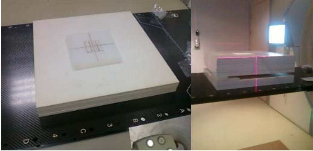
Şekil 3.5. Dozimetreleri ışınlanmak üzere hazırlanmış olan düzenek
