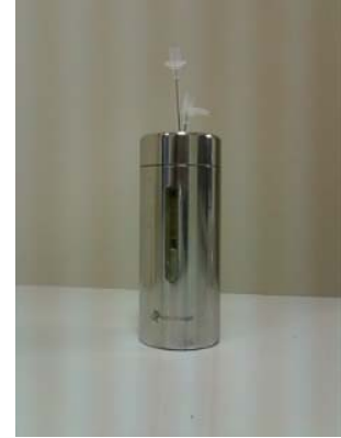
Şekil 2.16. Vialin zırhladığı kurşun kılıf
