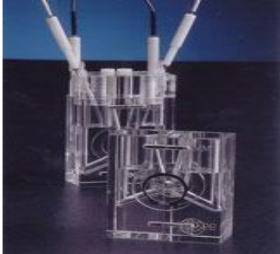
Resim 5. Hücre geçiş çalışmalarında kullanılan dikey difüzyon hücresi
