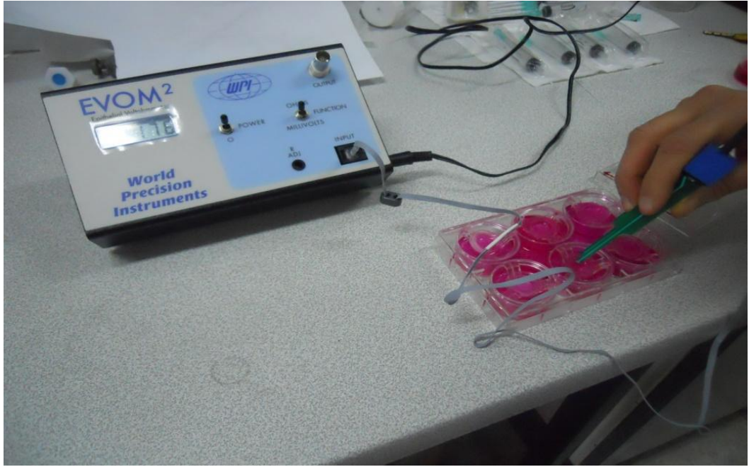
Resim 7. Evom Voltmeter® aleti ile TEER ölçümü sırasında çekilen fotoğraf
