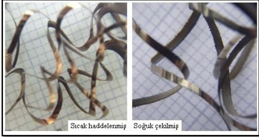
Şekil 6.15. 0,1 mm/dev ilerleme miktarında oluşan talaş görüntüleri.
