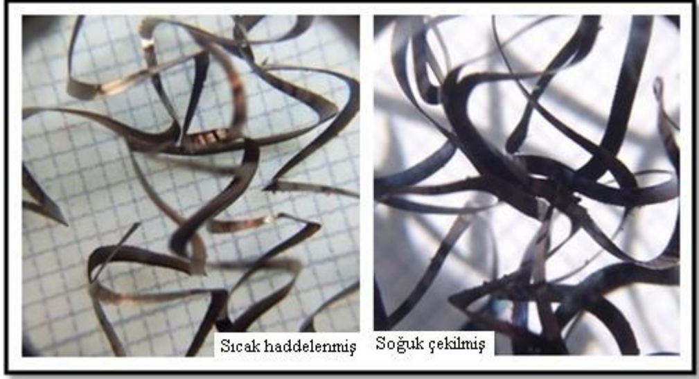
Şekil 6.11. 330 m/dak kesme hızında oluşan talaşların görüntüleri.
