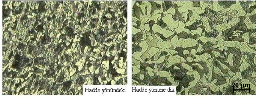
Şekil 6.2. Ø21,4 mm sıcak haddelenmiş deney malzemesinin mikroyapı görüntüsü.
