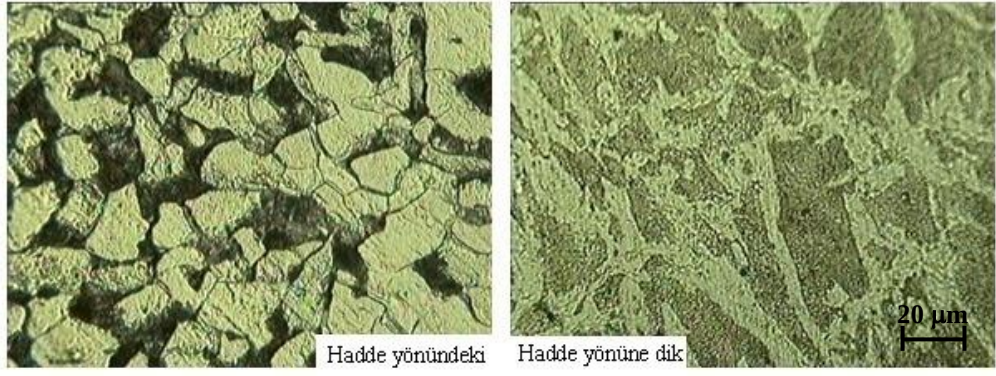
Şekil 6.5. Ø35 mm soğuk çekilmiş deney malzemesinin mikroyapı görüntüsü.
