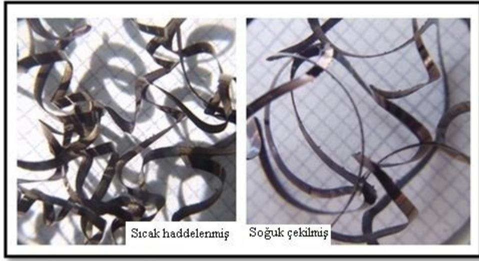
Şekil 6.13. 150 m/dk kesme hızında talaş görüntüleri.
