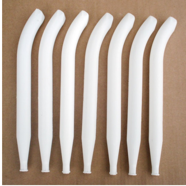
Şekil 9.13 Plastik sulu sıkılama kartuşları.
