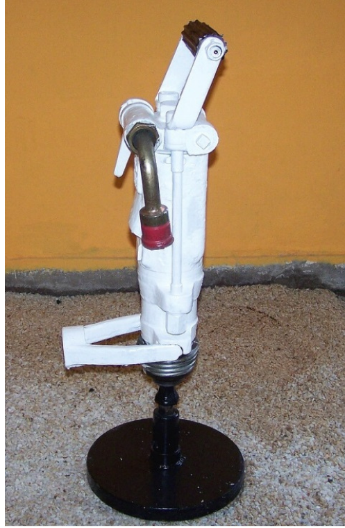
Şekil 9.3 TTK MAZ tipi martoperforatör.
