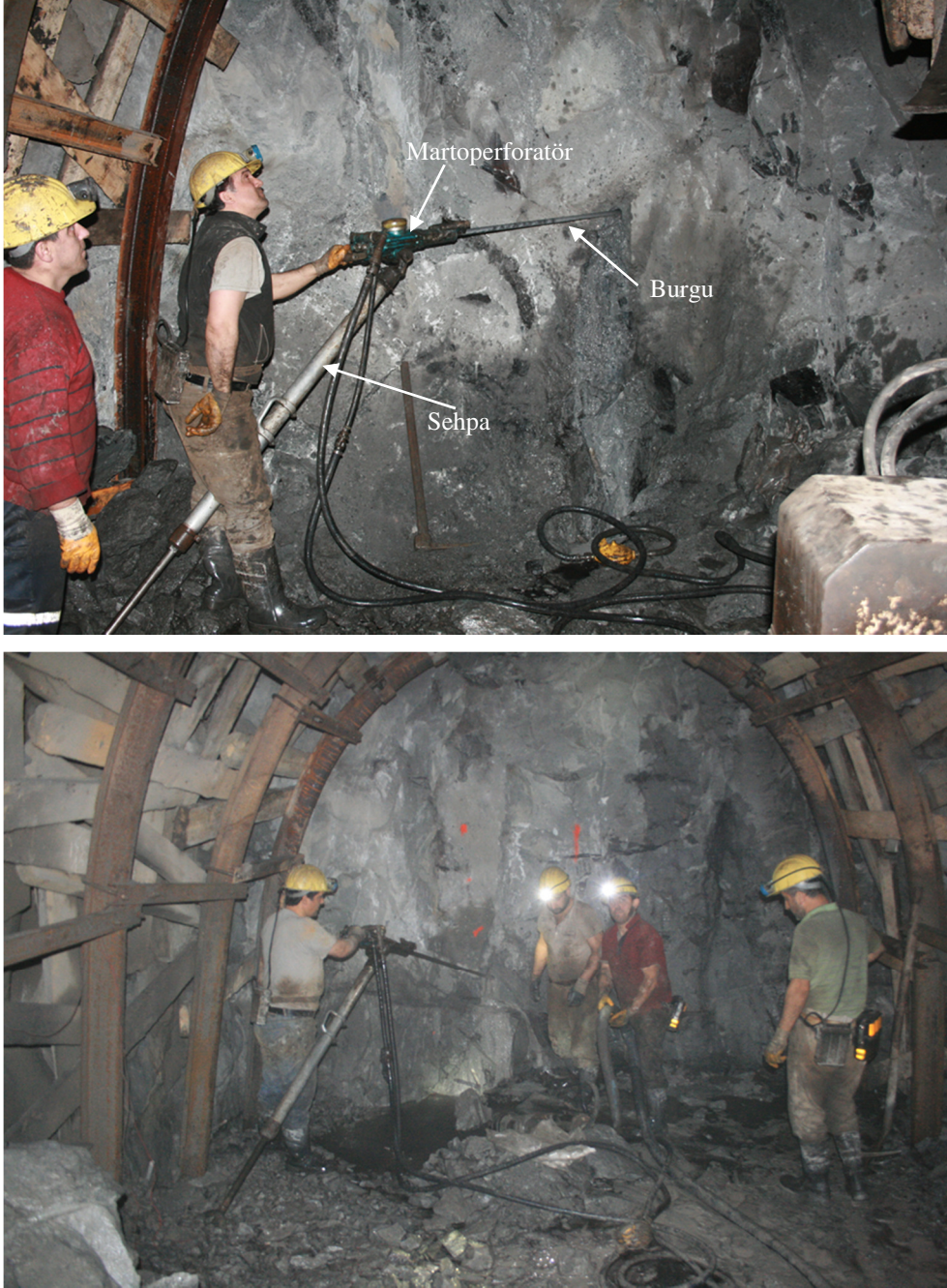
Şekil 9.4 Deliklerin delinmesinde kullanılan sehpalı delici makine (üste) ve deliklerin sehpalı delici ile delinmesi sırasında ocaktaki vardiya işçileri (altta).
