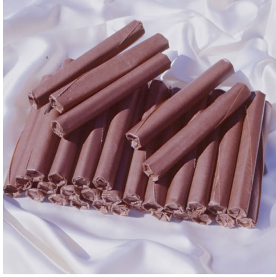
Şekil 9.1 Grizutin klorür dinamitin genel görünümü.
