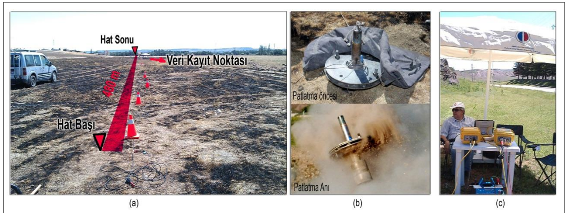
Şekil 4. 52: (a) Hat başından bir fotoğraf (b) Patlatma ekipmanı (P Gun) ve patlatma anından bir fotoğraf (c) veri kayıt sisteminden bir fotoğraf.
