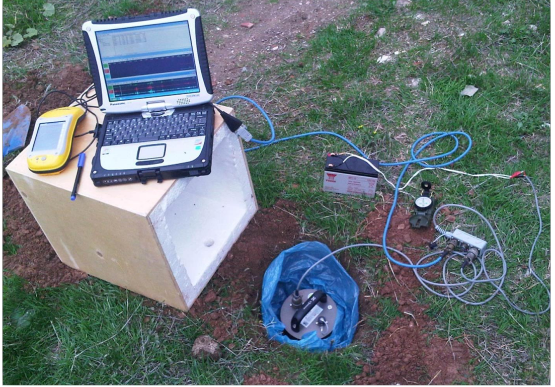
Şekil 3. 4: Guralp CMG-6TD kayıtçı sisteminin arazide yerleştirilmesi ve veri kaydı alınmasından bir görüntü.
