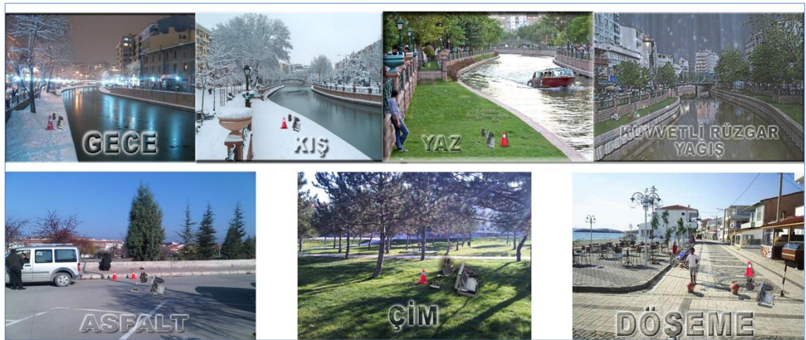
Şekil 3. 1: Farklı zemin koşulları ve hava şartlarında mikrotremor ölçümlerinden fotoğraflar.
