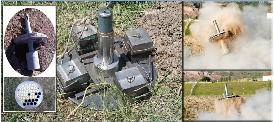
Şekil 3. 25: Çalışmada kullanılan P-Gun'ın yere montajı ve patlatma anı fotoğrafları.
