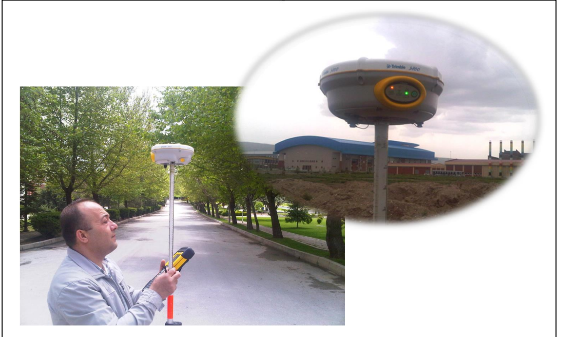
Şekil 3. 6: Çalışmada kullanılan gerçek zamanlı kinematik GPS ve uygulamadan bir fotoğraf.
