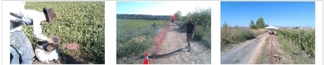
Şekil 4. 63: 4 Nolu SPAC ölçüm alanında P-Gun kullanılarak yapılan sismik çalışmadan üç fotoğraf. Fotoğraflar üzerindeki kırmızı çizgi hat doğrultusunu göstermektedir.
