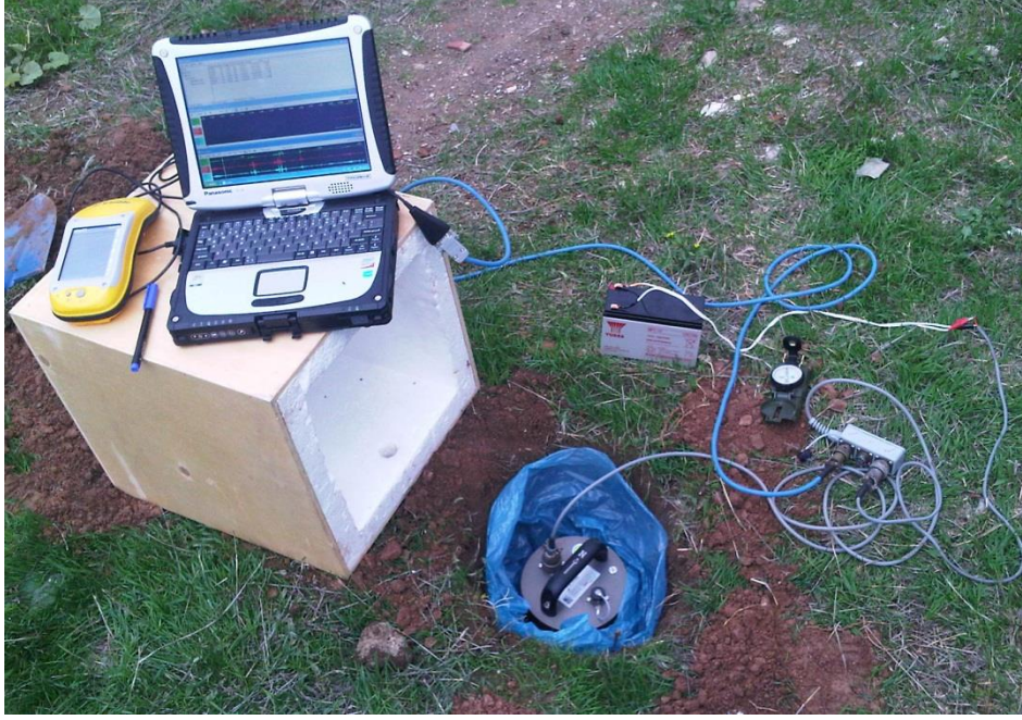
Şekil 4. 13: Guralp CMG-6TD kayıtçı sisteminin arazide yerleştirilmesi ve veri kaydı alınmasından bir görüntü.
